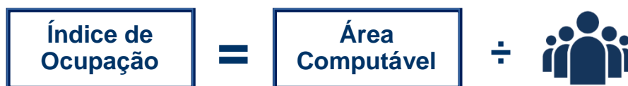
Figura 8: Cálculo de Índices de Ocupação, que pode ser utilizado tanto para o Índice de Ocupação Bruto quanto para o Índice de Ocupação estimado.
