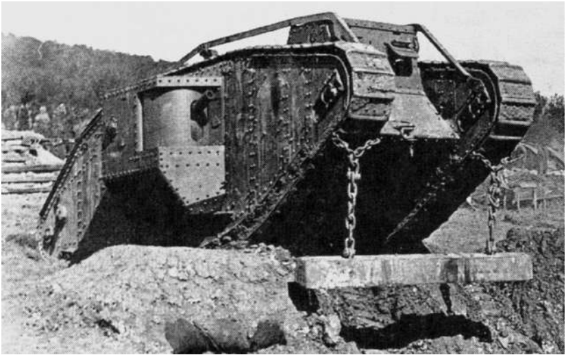
Figura 14 – Emprego do Beam pelo Tanque
