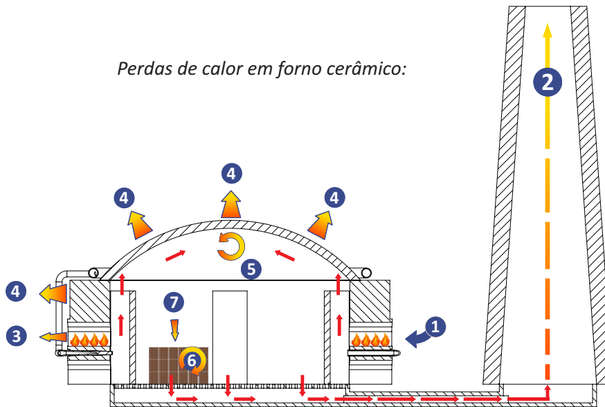
Fluxo de calor em forno cerâmico
