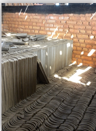
Arranjo tradicional de telhas sempre na mesma posição (compactadas) e sem espaços para passagem dos gases quentes
