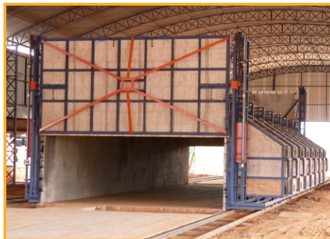
Forno metálico móvel
