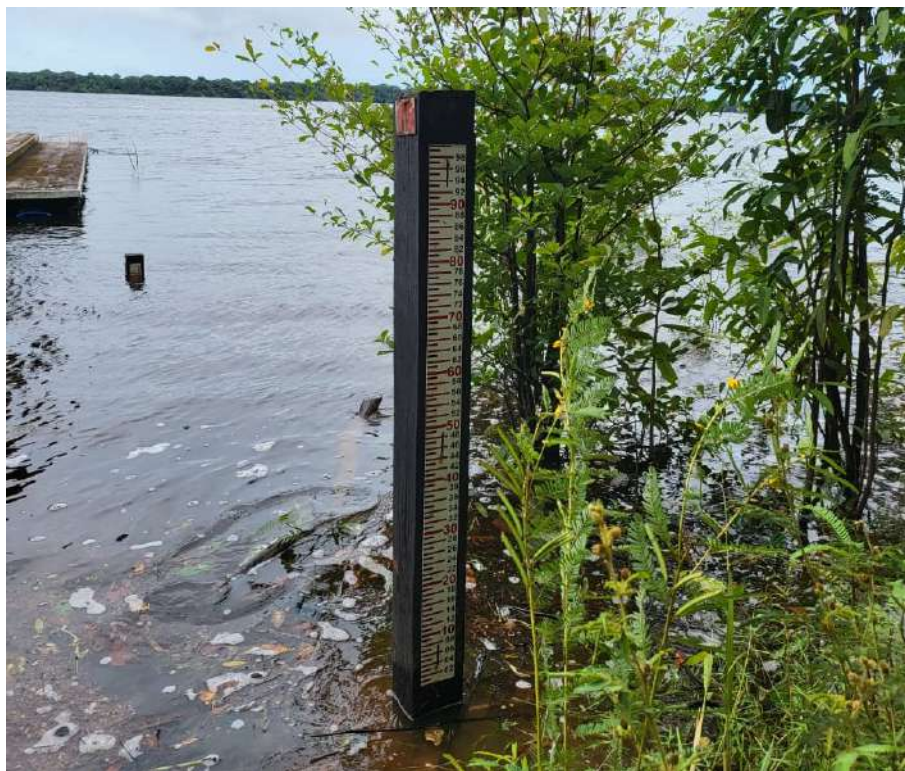
Figura 41 – Georreferenciamento da régua linimétrica em Novo Airão
