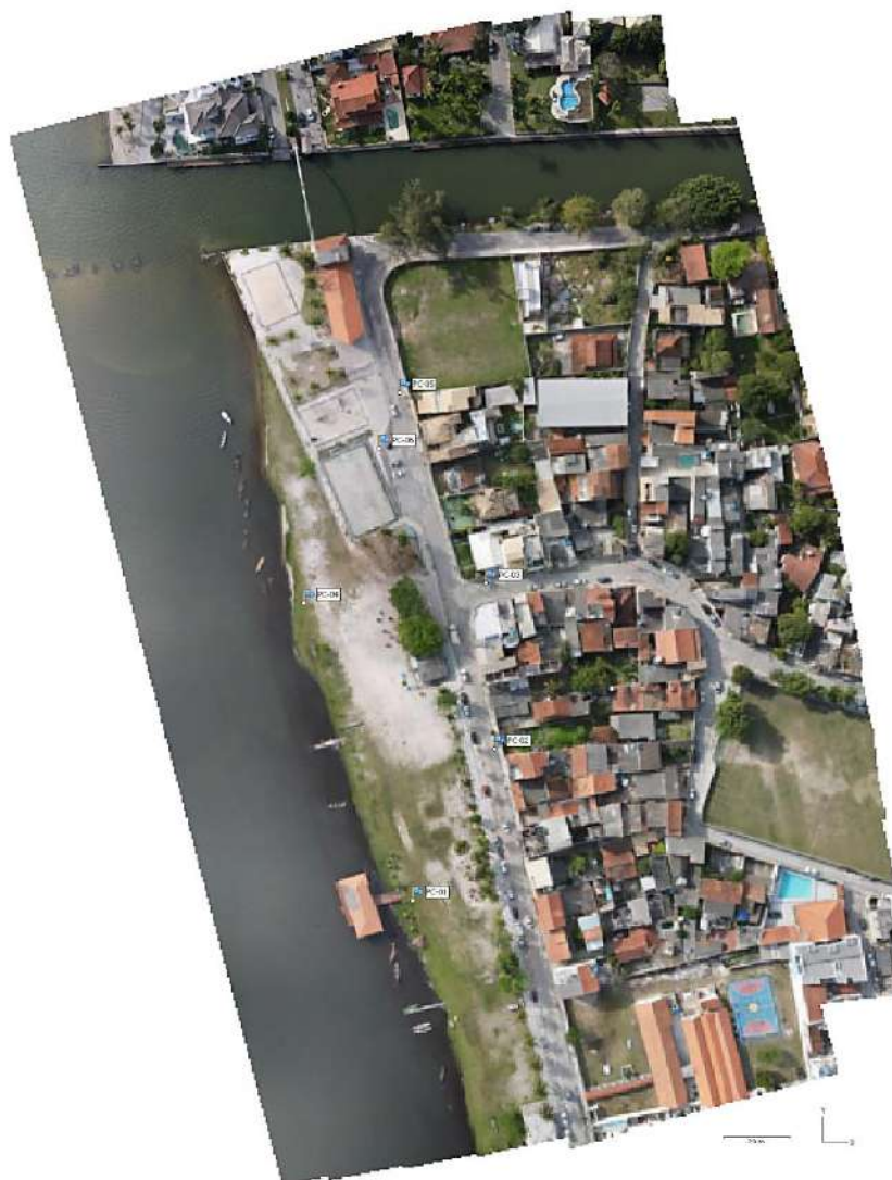
Figura 15 – Ortofoto da área fotografada + localização pontos de controle
