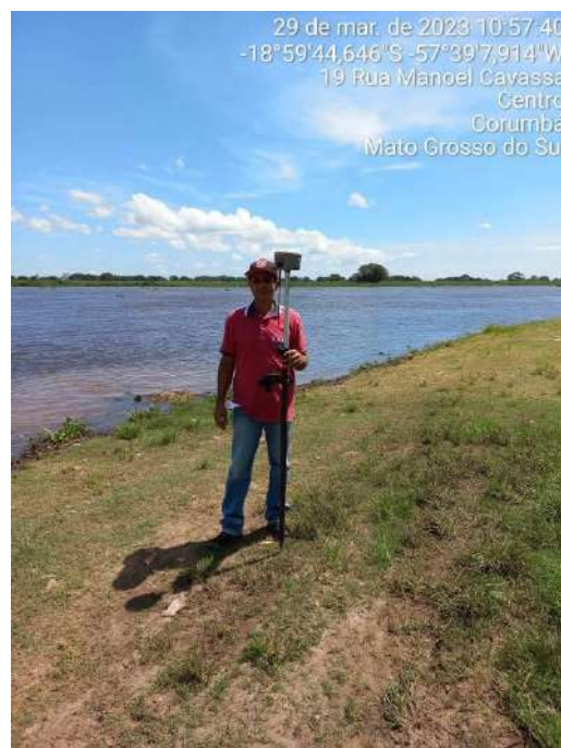
Fotos 9 e 10 - Levantamento das cotas Altimétricas do terreno
