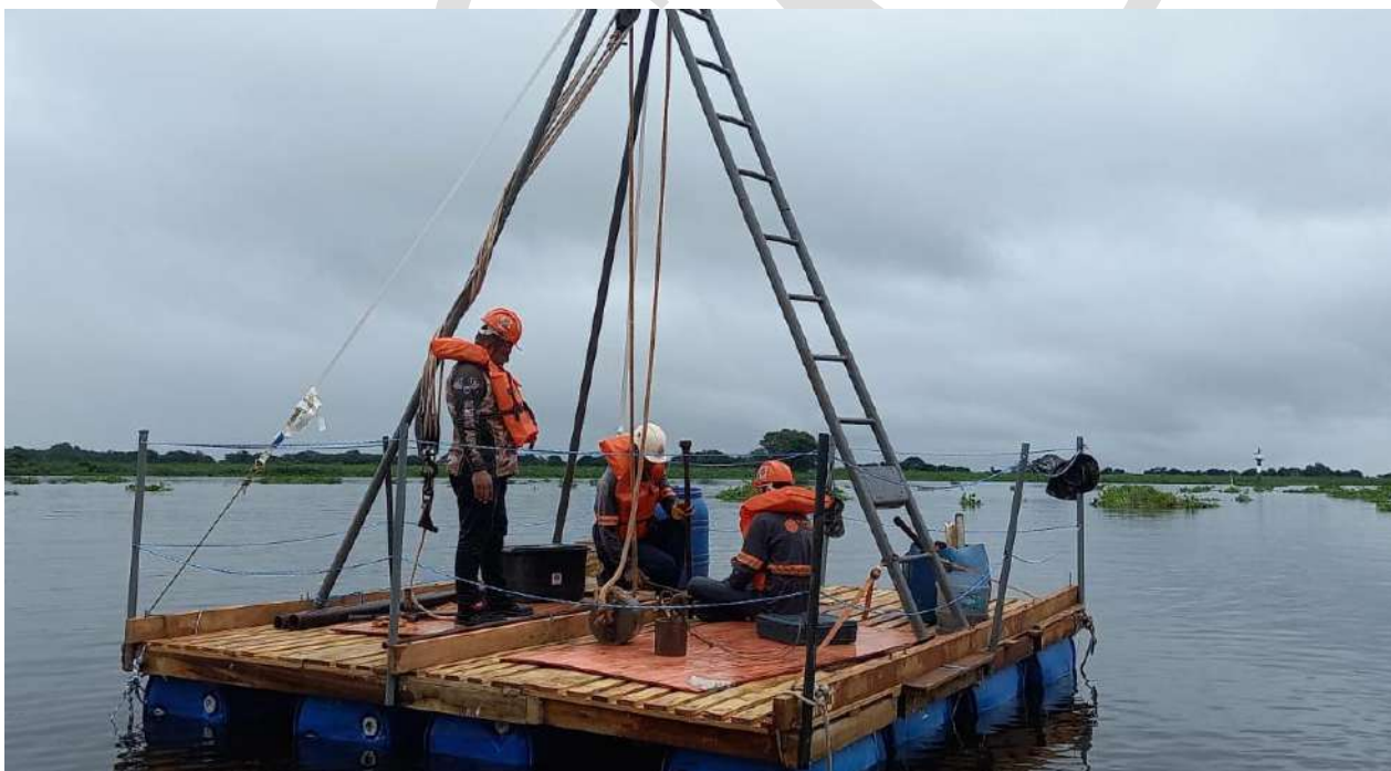
Fig. 8 – segurando a haste para marcação das 3 sequências de 15 centímetros
