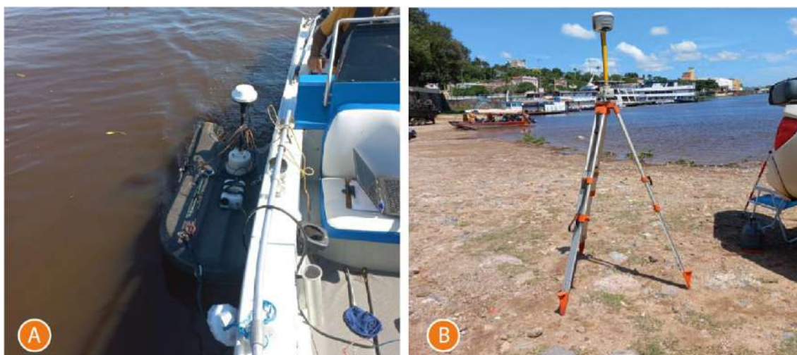
Figura 40 – Realização dos levantamentos: a) batimétrico; b) topográfico
