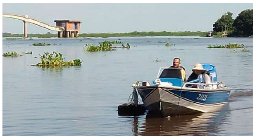
Fotos 5 - Levantamento da profundidade - Sensor ADCP na lateral do barco
