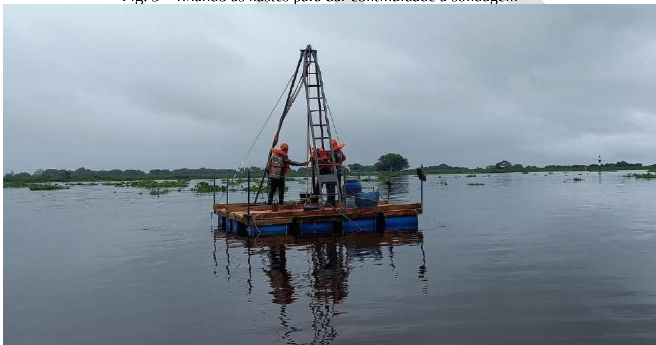
Fig. 10 – posicionando peso padrão para dar continuidade a sondagem
