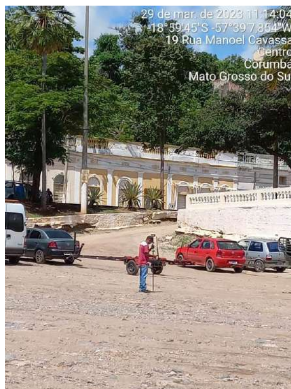
Fotos 7 e 8 - Levantamento das cotas Altimétricas do terreno
