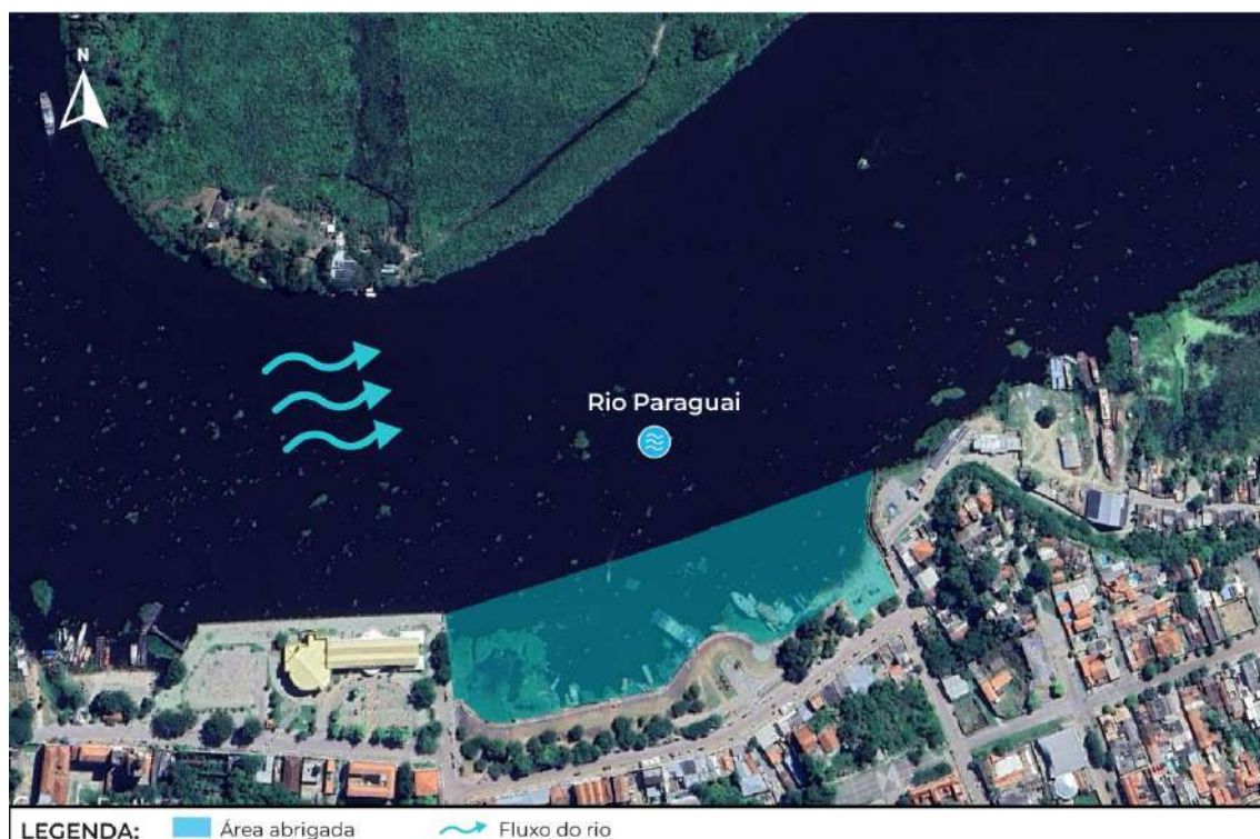
Figura 25 – Área abrigada pela estrutura do Porto Geral de Corumbá
