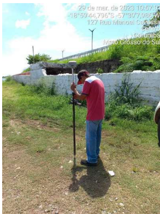
Fotos 9 e 10 - Levantamento das cotas Altimétricas do terreno
