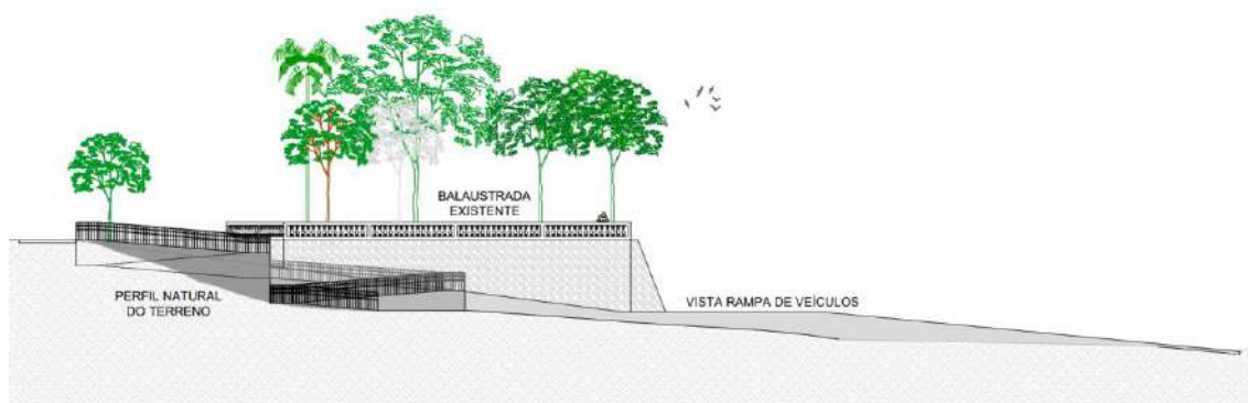
Figura 37 – Corte esquemático da rampa náutica proposta para o município de Corumbá Elaboração: LabTrans/UFSC (2023)
