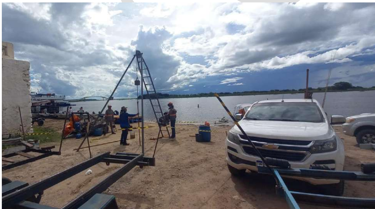
Fig. 4 – guiando peso padrão para o avanço da sondagem
