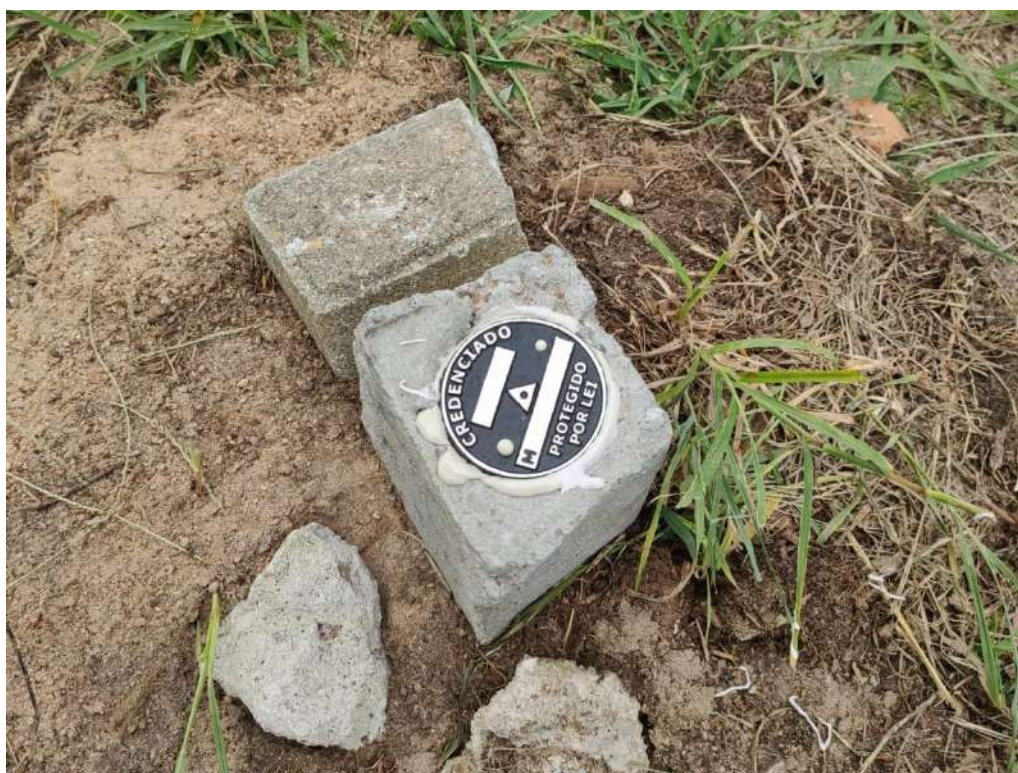
Figura 2 – Imagem do marco de amarração instalado junto a orla da lagoa.
