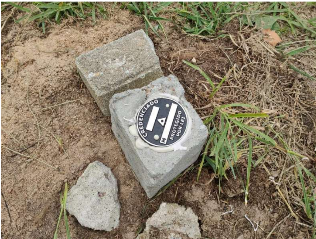
Figura 2 – Imagem do marco de amarração instalado junto à orla da Lagoa dos Patos.
