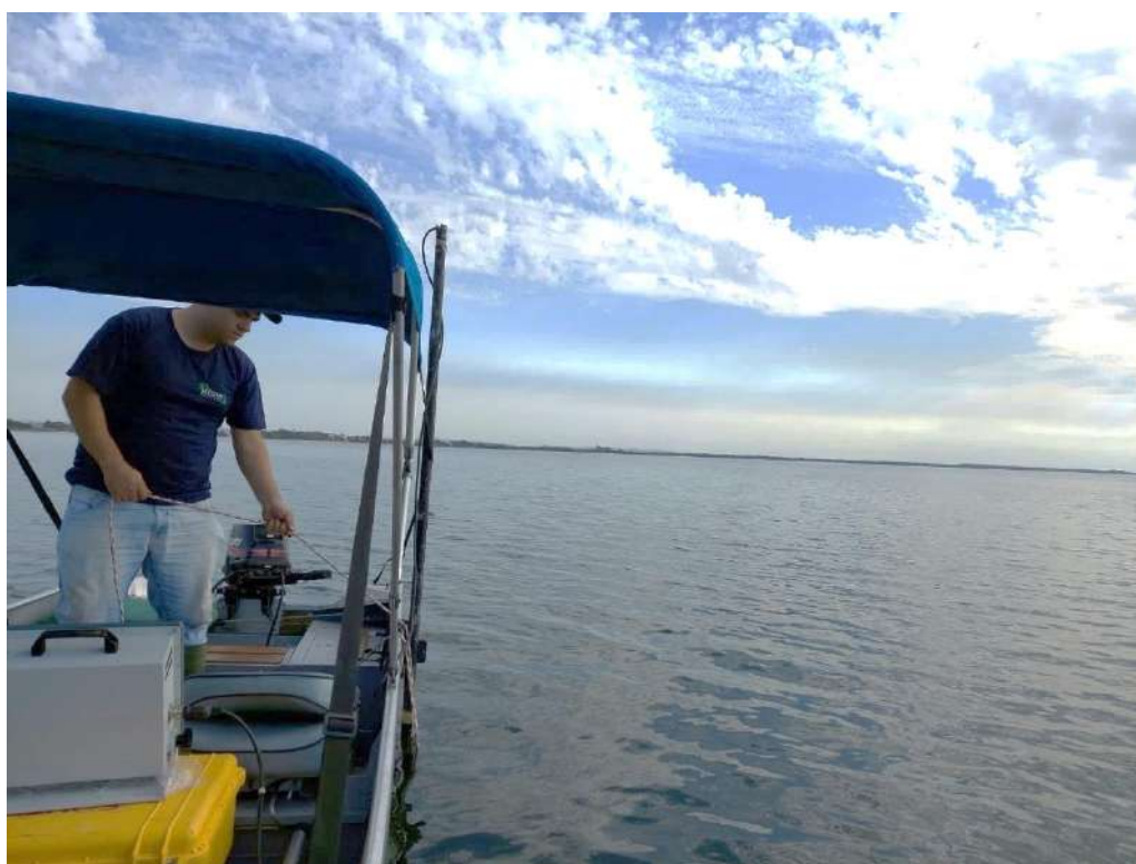
Figura 3 – Imagem do levantamento para determinação da velocidade do som na água pelo método bar-check.
