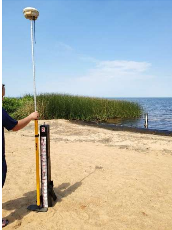
Imagem 01: Vista das régua linimétrica da CPRM, em primeiro plano a régua de 2 m, em segundo plano, ao fundo, a régua de 1 m.
