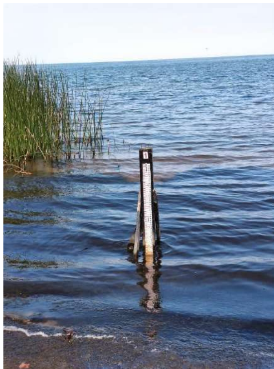
Figura 04: Vista da Régua linimétrica de 1 m da Estação Fluviométrica São Lourenço.
