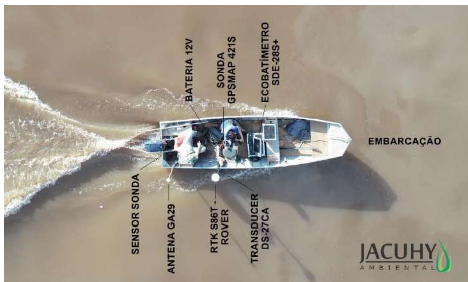
Figura 5 – Disposição dos Equipamentos na Embarcação.
