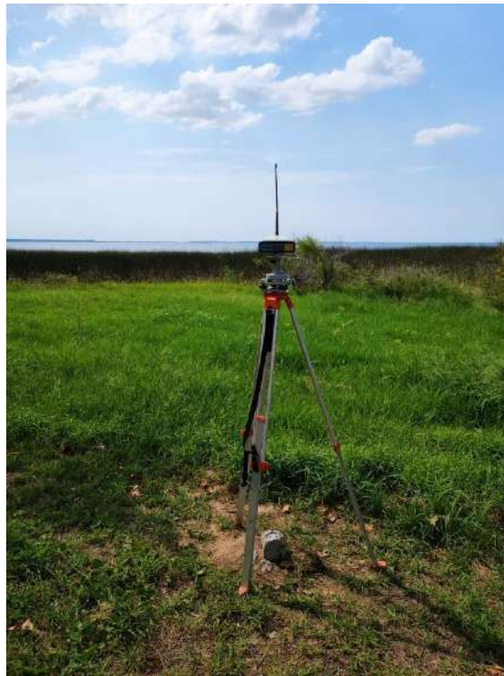
Imagem 03: Equipamento instalado como base sobre o marco de referência para o levantamento.
