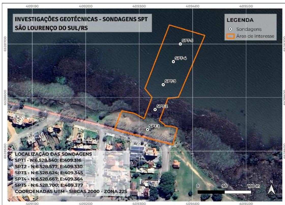
Figura 31 – Localização dos furos de sondagem a percussão (SPT)
