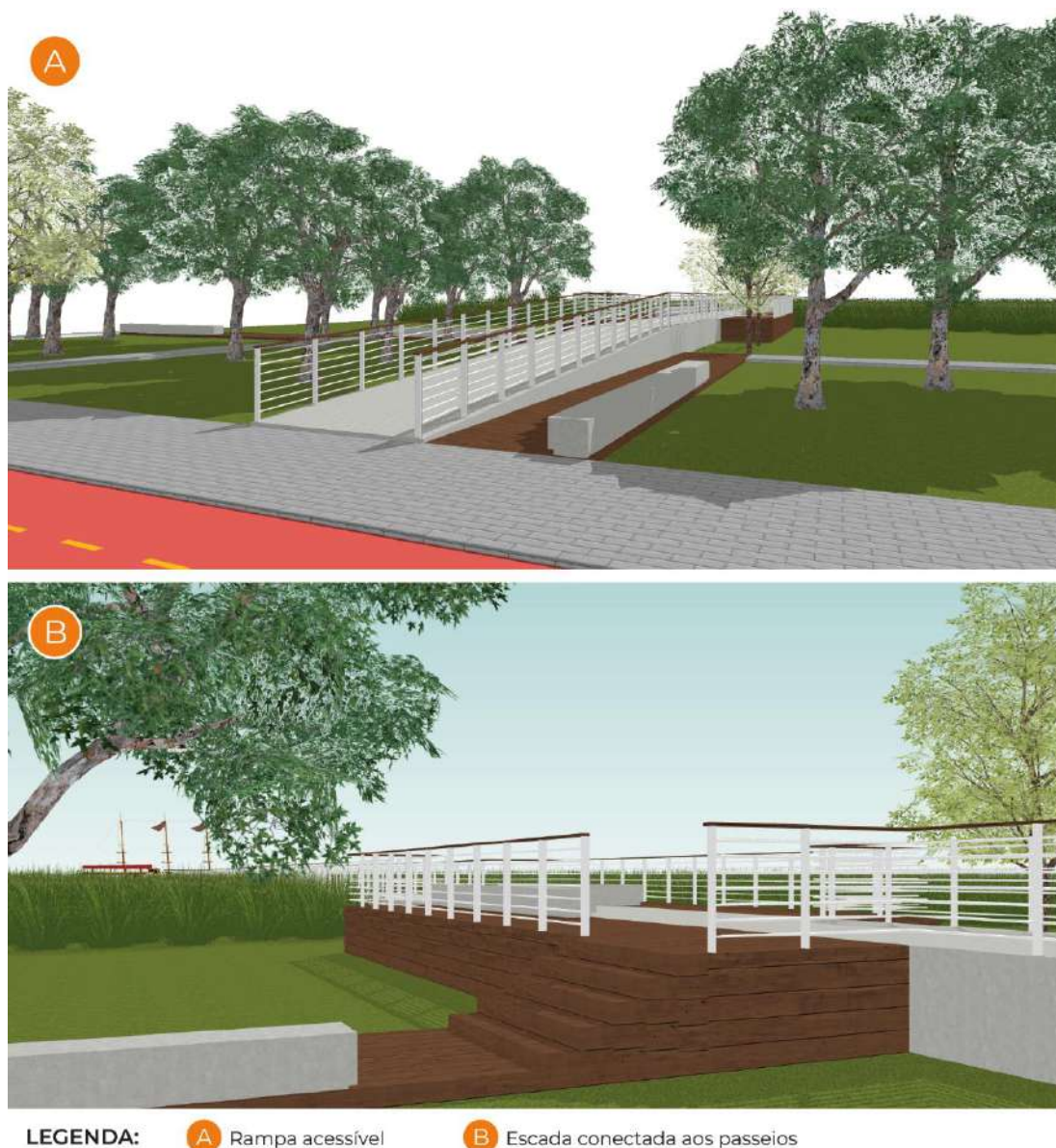
Figura 29 – Acesso de pedestres ao píer Elaboração: LabTrans/UFSC (2023)
