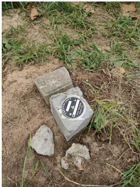
Imagem 02: Marco de referência instalado pela equipe Jacuhy Ambiental.
