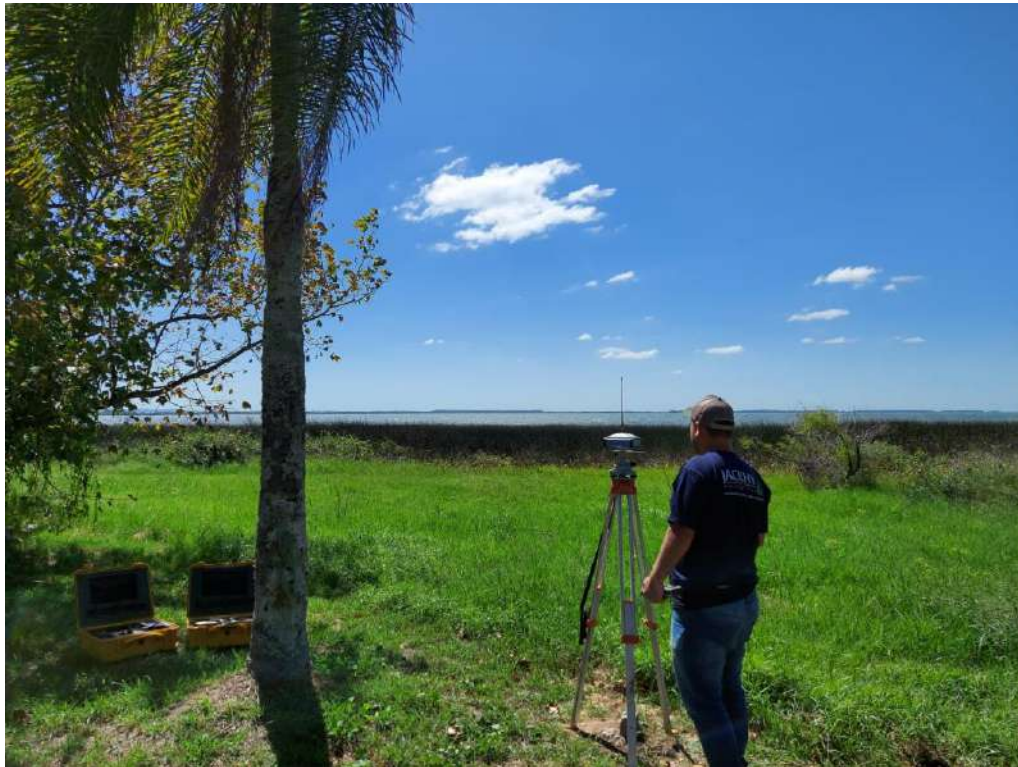
Figura 2 – Equipamento “base” instalado sobre o marco referencial, junto a orla de São Lourenço do Sul.
