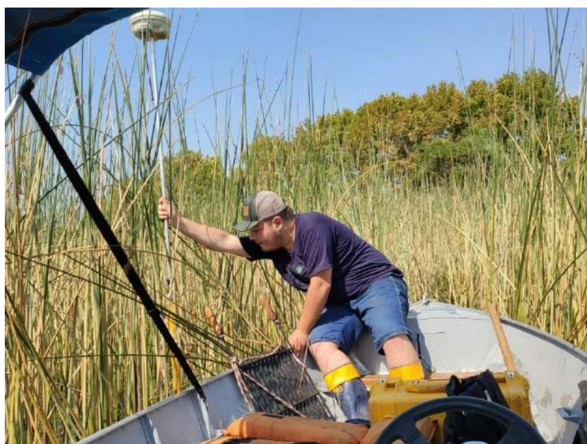
Figura 9 – Coleta de dados com GNSS RTK em área alagada com vegetação.
