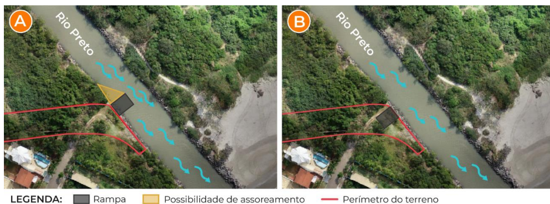
Figura 24 – Estudo do posicionamento da rampa náutica Fonte: Google Earth (2023). Elaboração: LabTrans/UFSC (2023)
