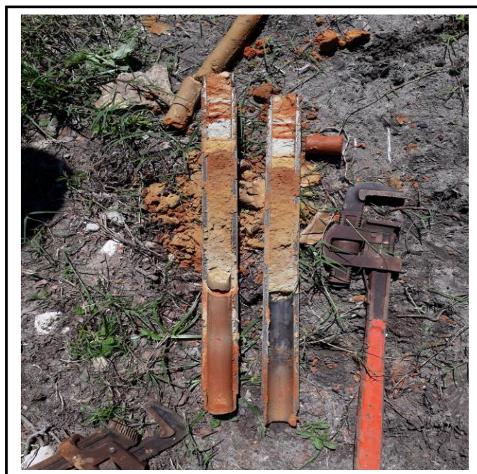
AMOSTRADOR UTILIZADO NAS SONDAGENS
