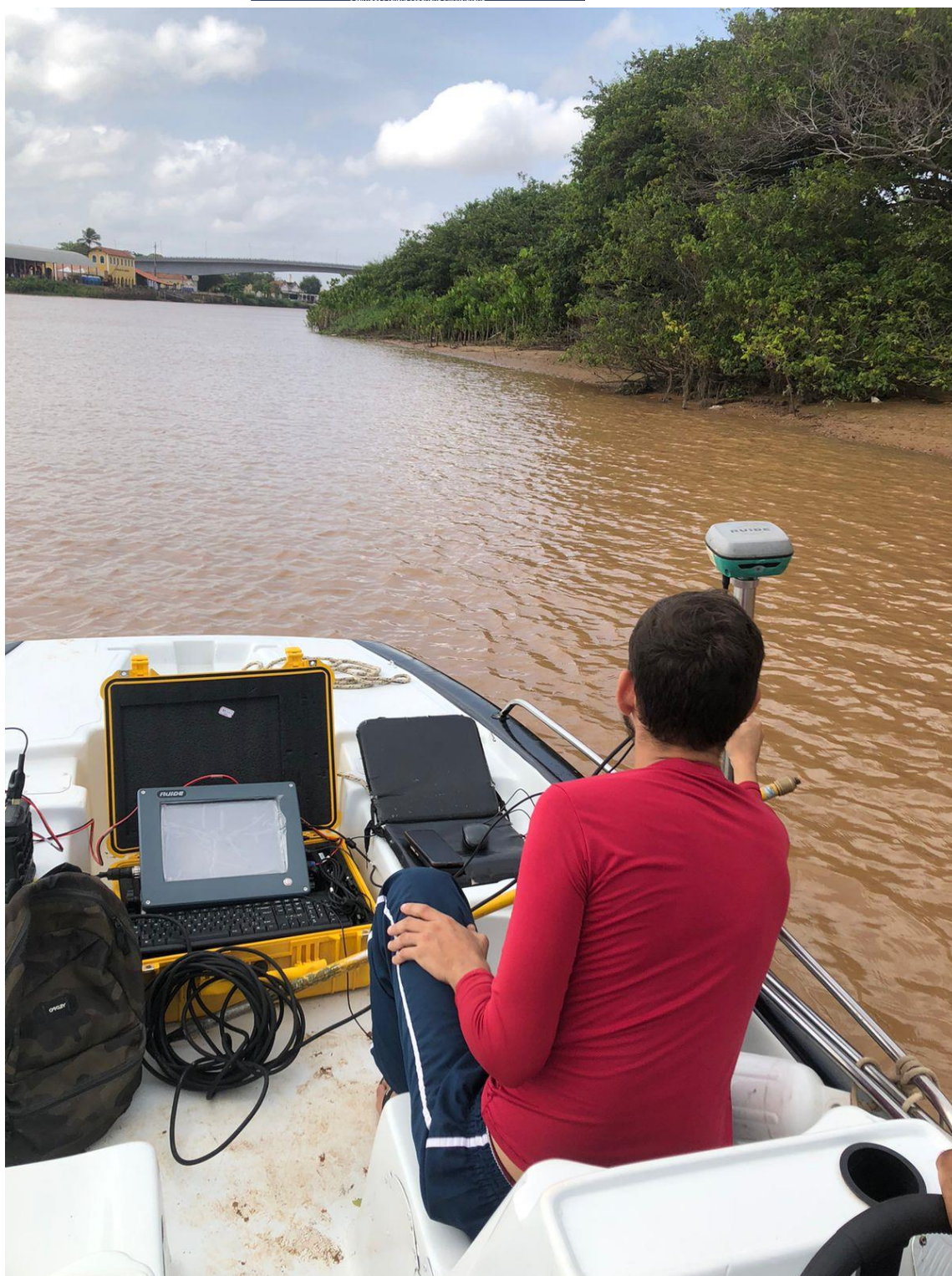
Imagem 5 – Execução e acompanhamento da batimetria com o ecobatímetro SOUTH SDE-28S+.
