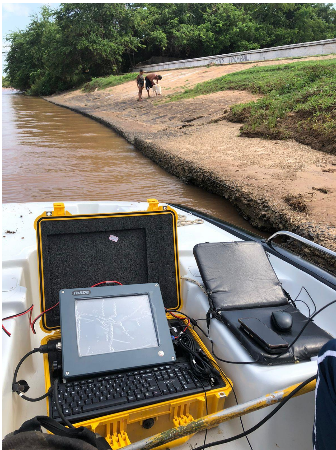
Imagem 4 – Instalação e configuração do ecobatímetro SOUTH SDE-28S+.
