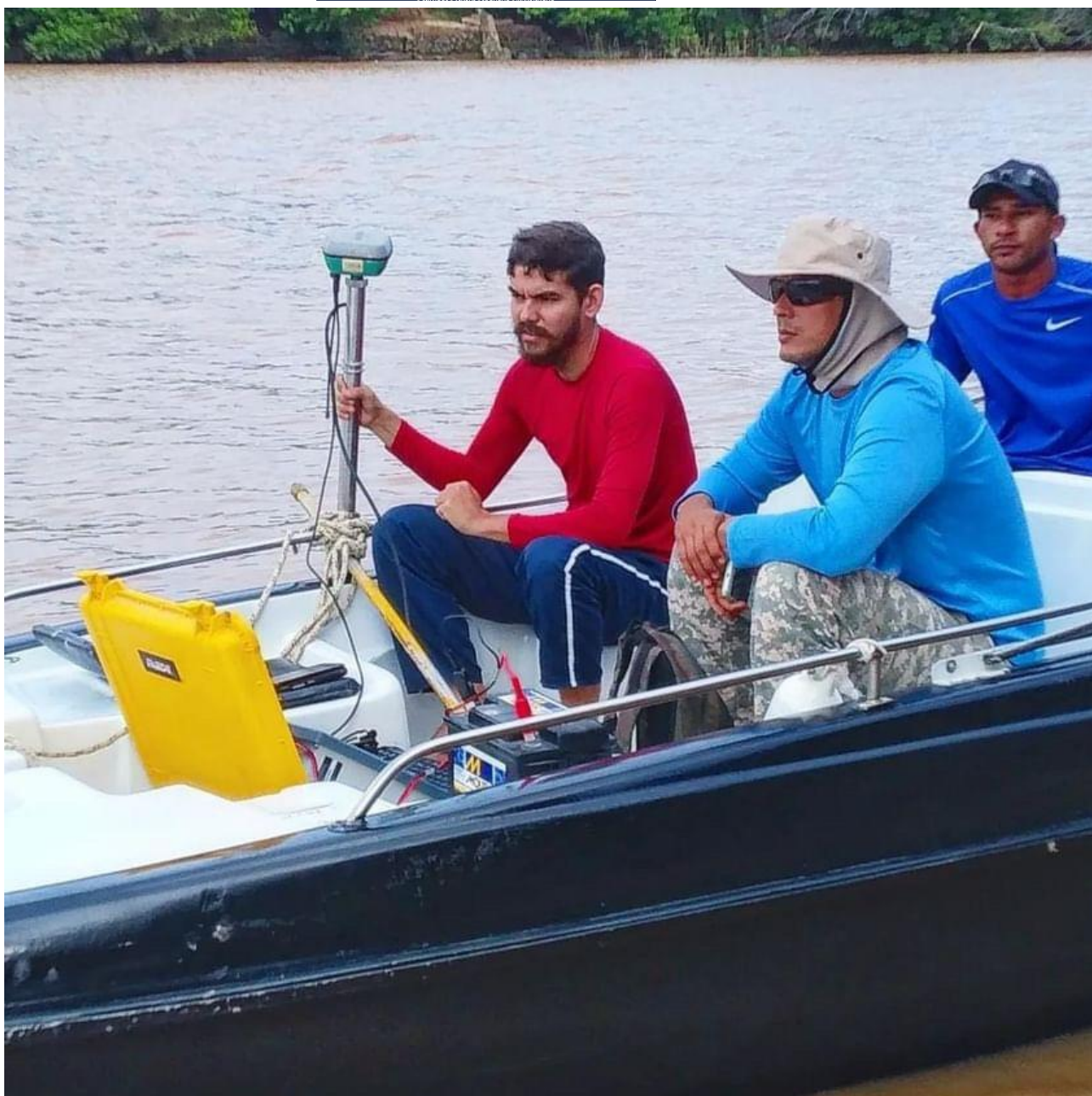
Imagem 6 – Equipe técnica na finalização da batimetria com o ecobatímetro SOUTH SDE-28S+.
