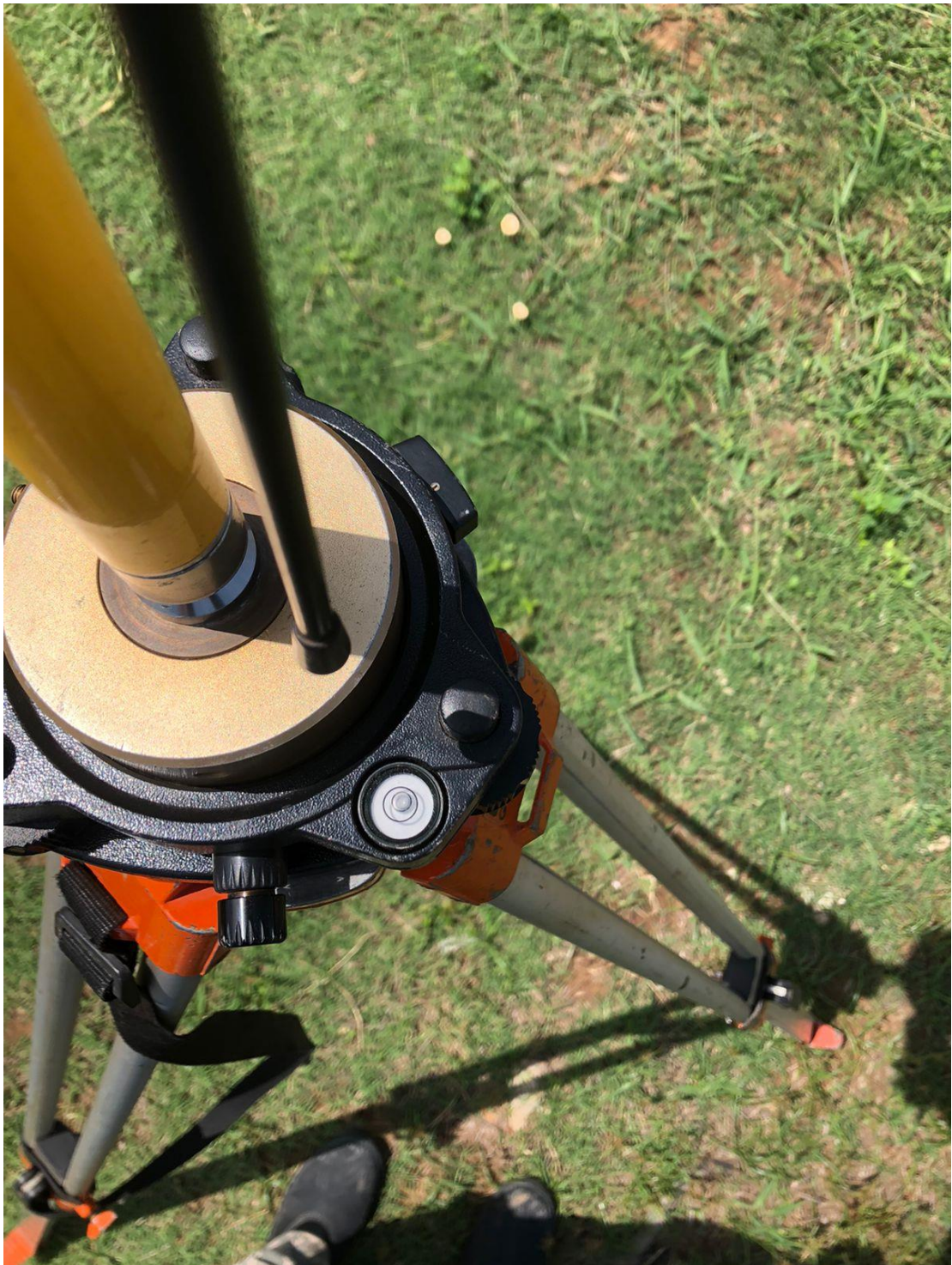
Imagem 3 – Nivelamento da Base Geodésica de apoio.
