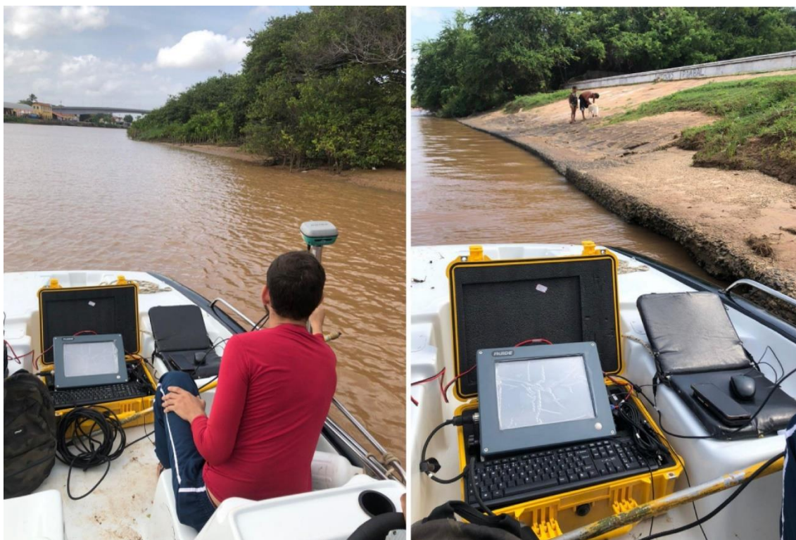
Figura 13 – Realização do levantamento batimétrico
