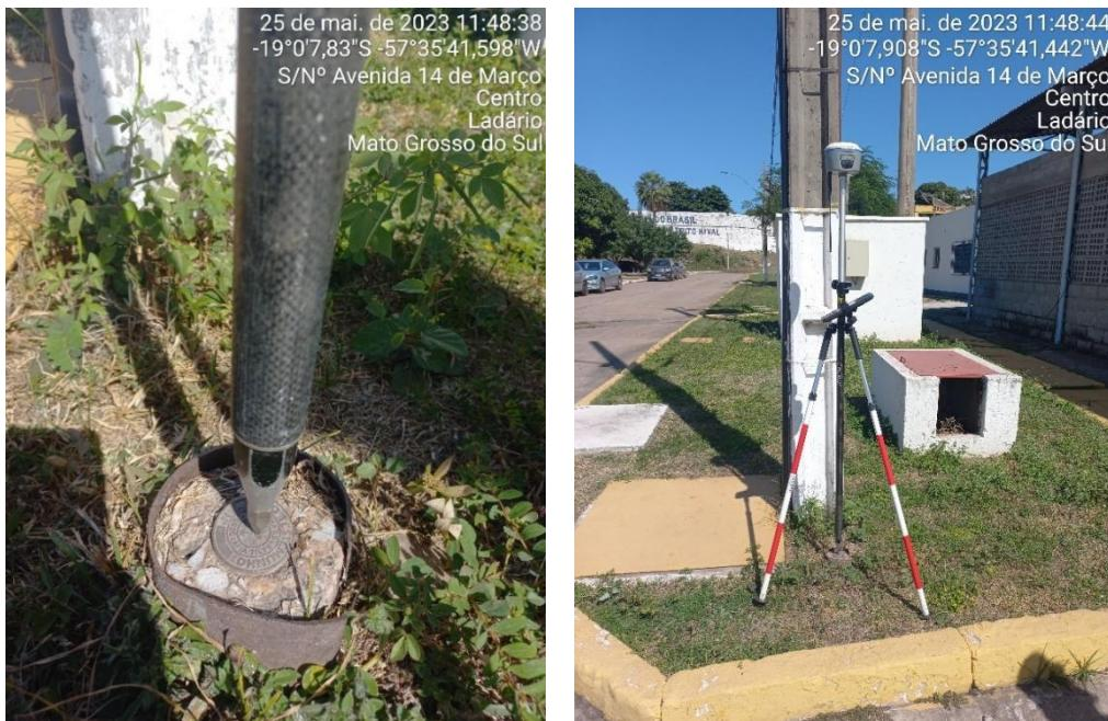
**RN-5 CPRM** – Materializada por um pino de metal, instalado e mantido pela CPRM, concretado na base de um pilar de concreto, localizada atrás do Prédio da Administração do Dique, seguindo o prolongamento da rua, cerca de 23 metros a ré da RN-4 CPRM. Citada a partir de 2021.
