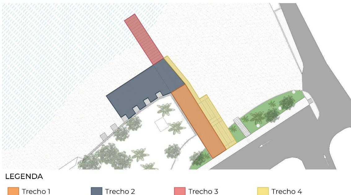
Figura 32 – Trechos da rampa náutica com rampa acessível de pedestres
