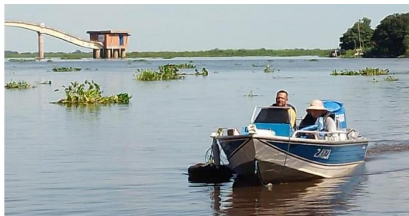
Fotos 5 - Levantamento da profundidade - Sensor ADCP na lateral do barco
