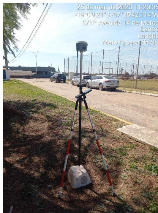
**RN-4 CPRM** – Materializada por um pino de metal, instalado e mantido pela CPRM, concretado na base de um pilar de concreto, localizada atrás do Prédio da Administração do Dique, seguindo o prolongamento da rua, cerca de 28 metros a ré da RN-4 DHN. Citada a partir de 2021.
