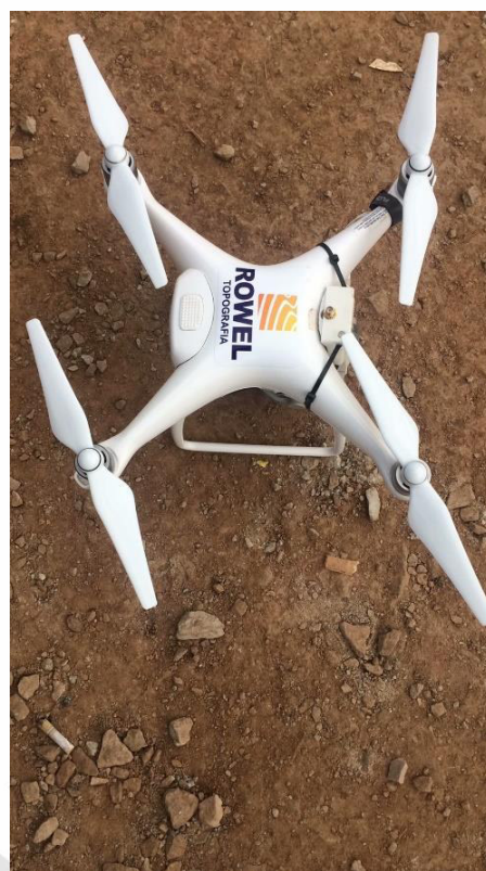
Figura 5-DRONE com PPK acoplado
