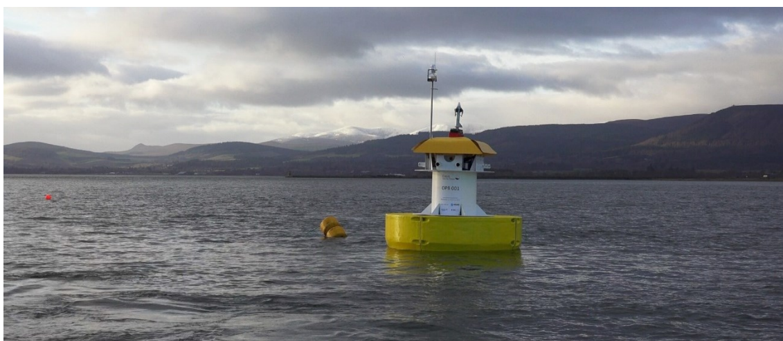
Figura 50 – Protótipo de boia de amarração com carregador elétrico no Reino Unido
