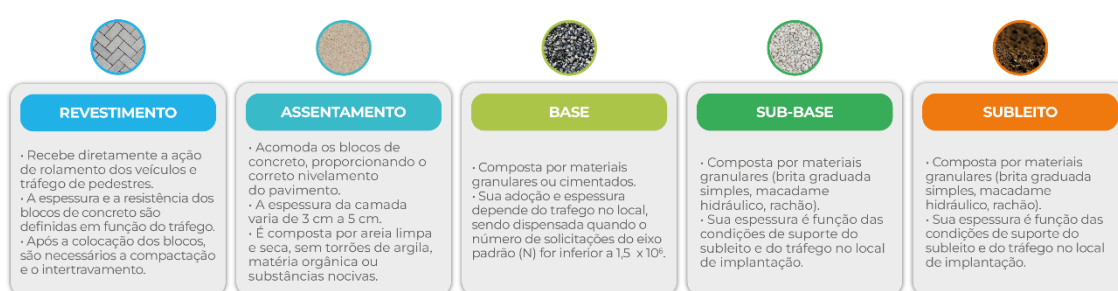
Figura 60 – Camadas da pavimentação com paver
