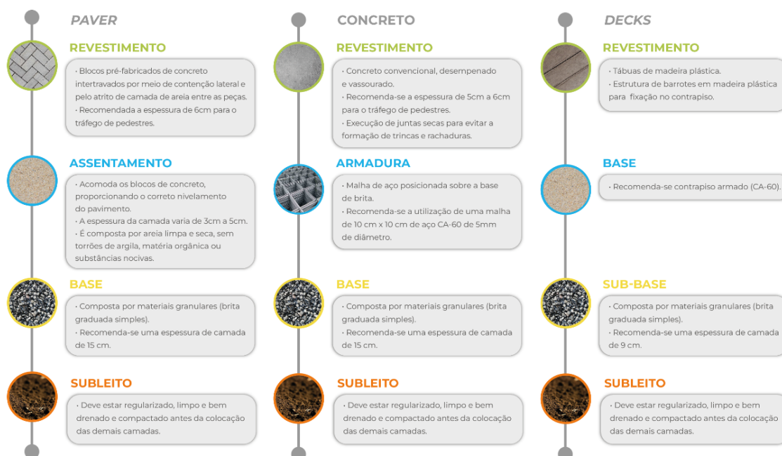
Figura 67 – Camadas da pavimentação de passeios e decks
