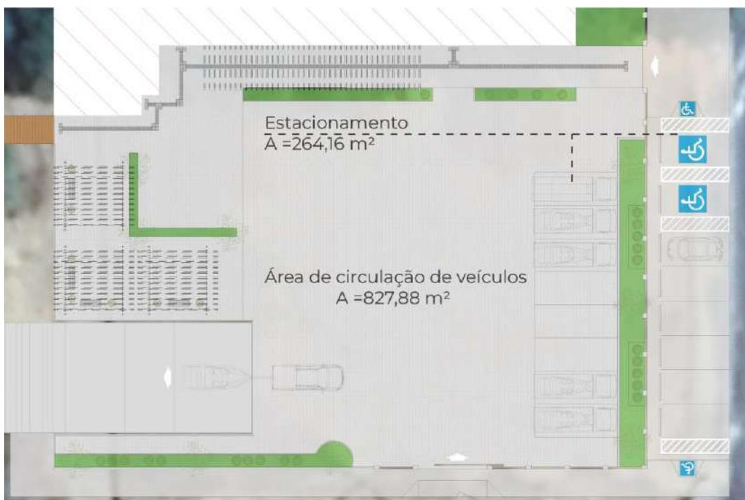
Figura 29 – Área de circulação de veículos e estacionamento
