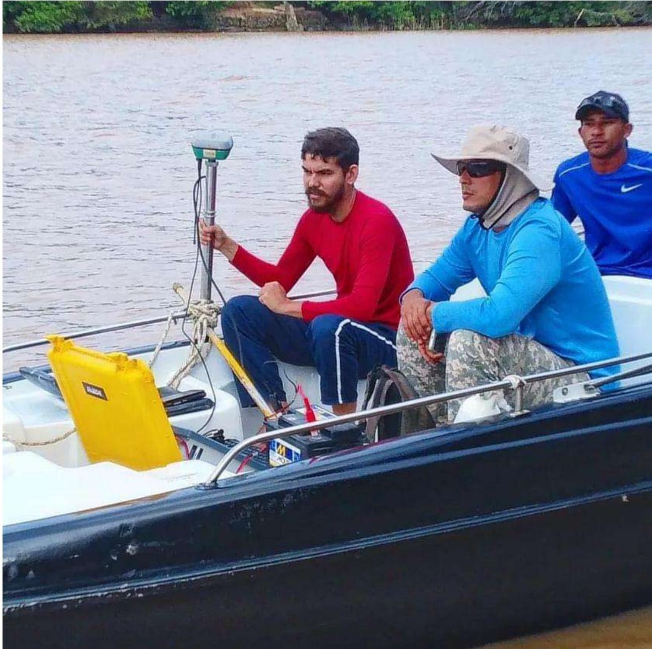
Imagen 6 – Equipe técnica na finalização da batimetria com o ecobatímetro SOUTH SDE-28S+.
