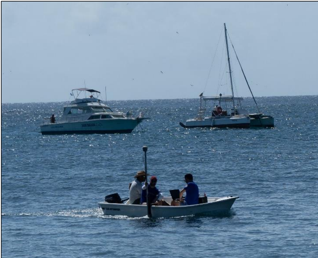
Foto 1 - Levantamento batimétrico sendo executado com os equipamentos instalados na embarcação
