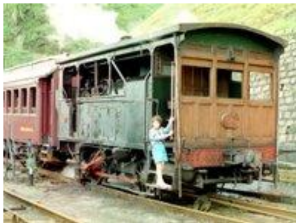
Figura 89 – Modelo: Locobrequê Kerr Stuart - Tipo 0-4-0 - Tração a vapor. Origem: Paranapiacaba - São Paulo
