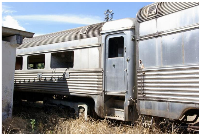
Figura 155 - Automotriz de aço inoxidável Budd
