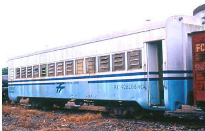
Figura 177 - Carro de aço carbono restaurante RC928208-4
