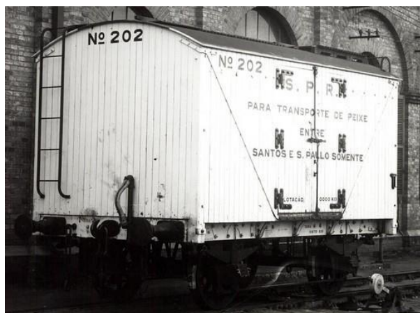
Figura 88 – Vagão de dois eixos da SPR (São Paulo Railway) utilizado no transporte de peixe de Santos a São Paulo. Foto de autor desconhecido.
