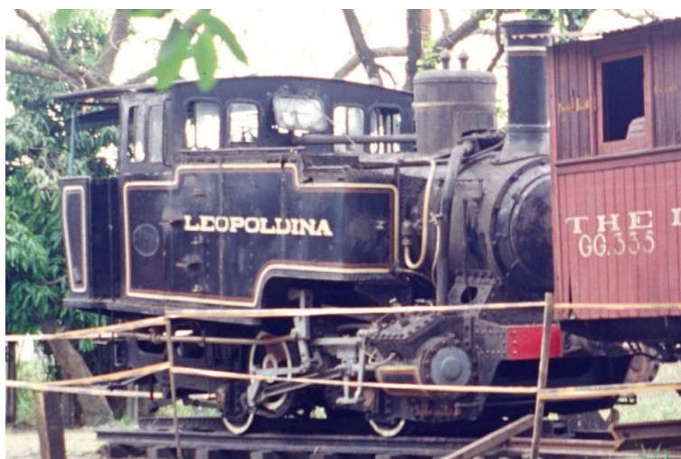
Figura 199 - Locomotiva a vapor cremalheira Esslinger, nº 1
