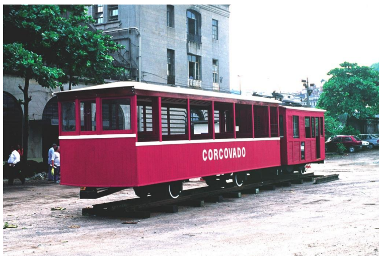
Figura 195 - Locomotiva elétrica SLM cremalheira nº 1 e carro
