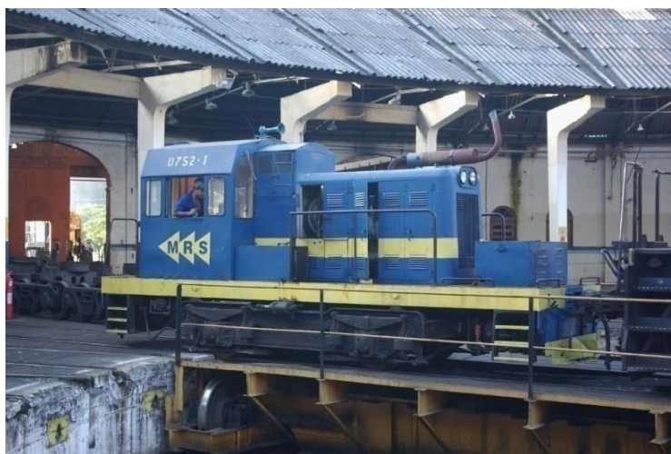
Figura 154 - Locomotiva diesel-elétrica 150 hp “Marcelina” nº 752
