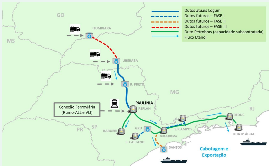
Figura XX: Plano de Expansão de dutos para o consumo interno de etanol
