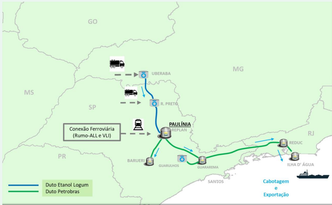
Figura XX: Plano de Expansão de dutos para o consumo interno de etanol
