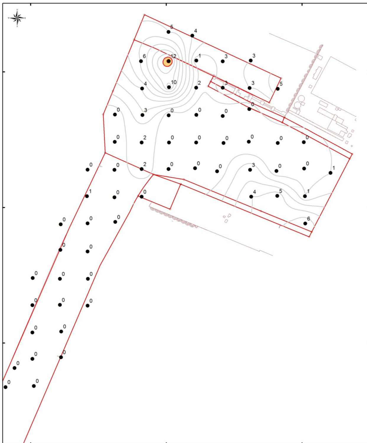
Figura 3.17: Mapa de índices máximos de resistência do substrato, até profundidade de projeto em cada área. Indicação de uma pequena região com SPT > 10 , considerada crítica, do ponto de vista da operação de dragagem com draga hopper de médio porte.
