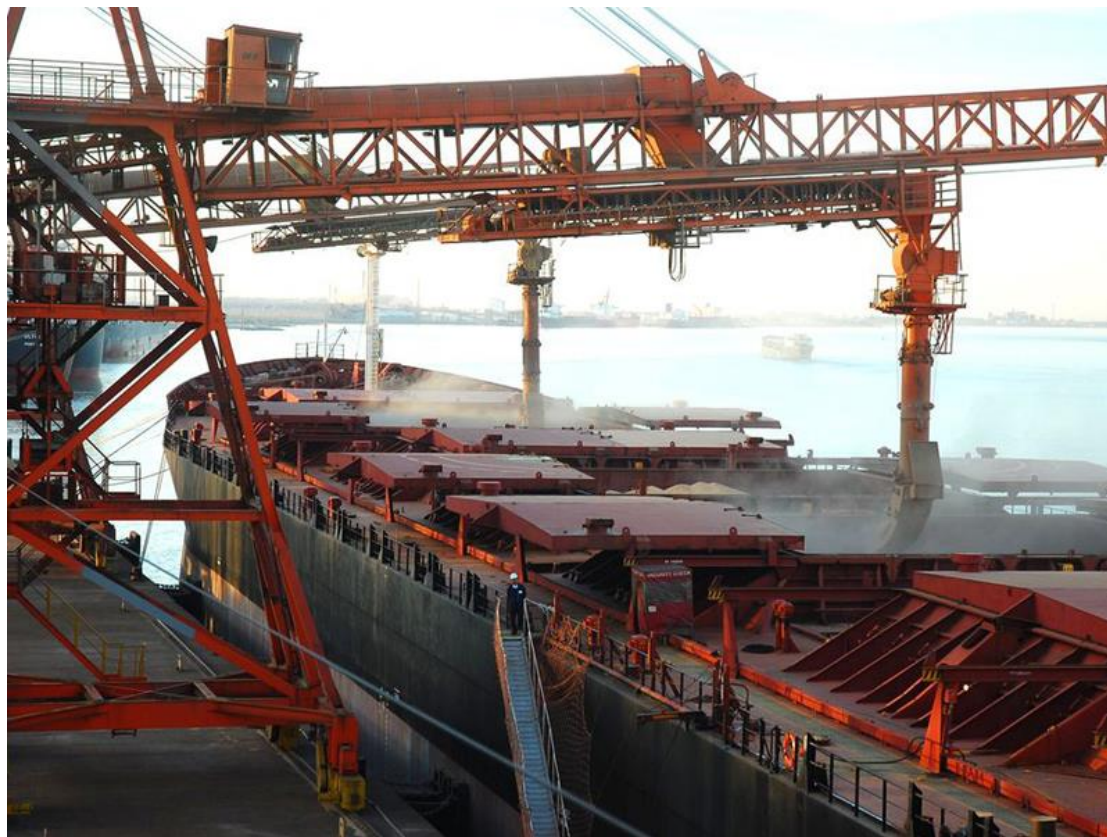
Figura 86. Operação de Embarque de Soja no TTS (Tergrasa) com o Emprego Simultâneo de Três Carregadores de Navios
