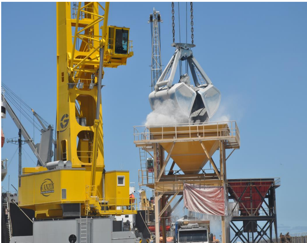
Figura 82. Descarga de Fertilizante no Porto Novo com Uso de MHC
