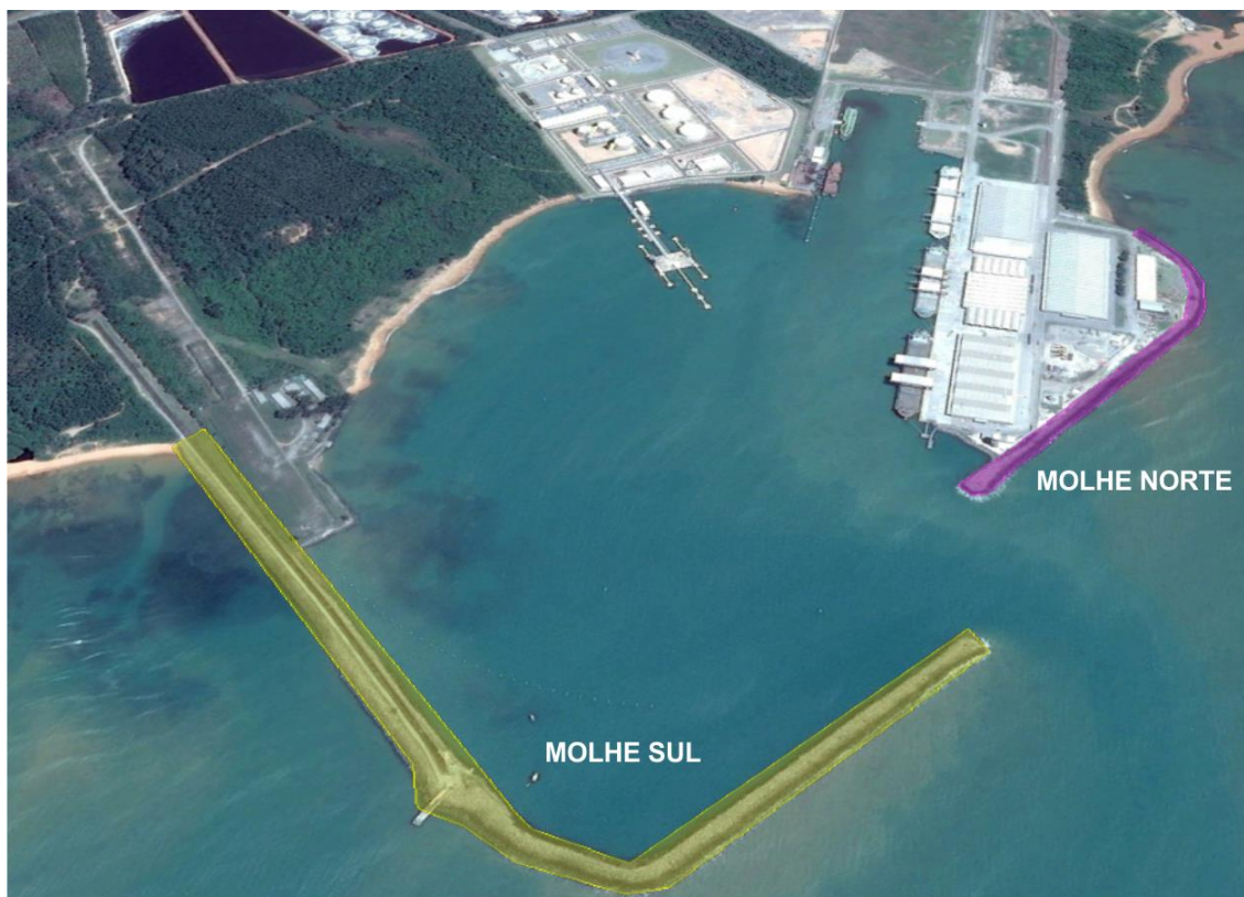
Figura 24. Identificação dos Molhes do Porto de Barra do Riacho
