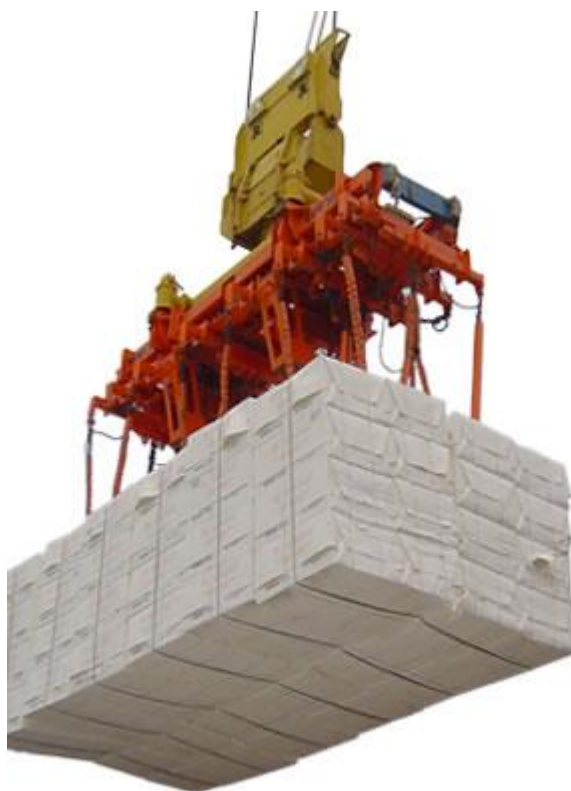
Figura 45. Arranjo dos Fardos de Celulose em Lingada para o Embarque
