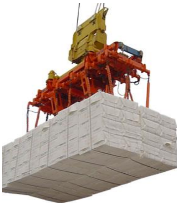
Figura 16. Arranjo dos Fardos de Celulose em Lingada para o Embarque Fonte: Portocel ([s./d.])
