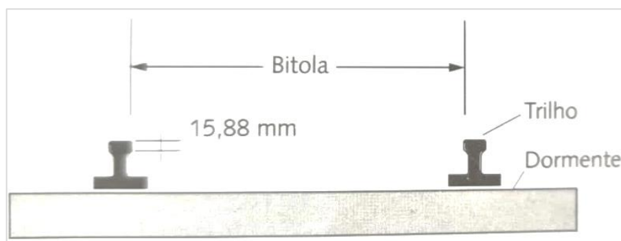
Figura 42 - Representação esquemática da bitola
