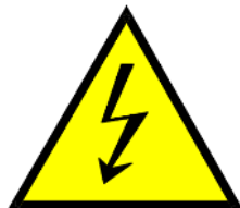
Figura 1 - Marcação de equipamento de alta tensão
