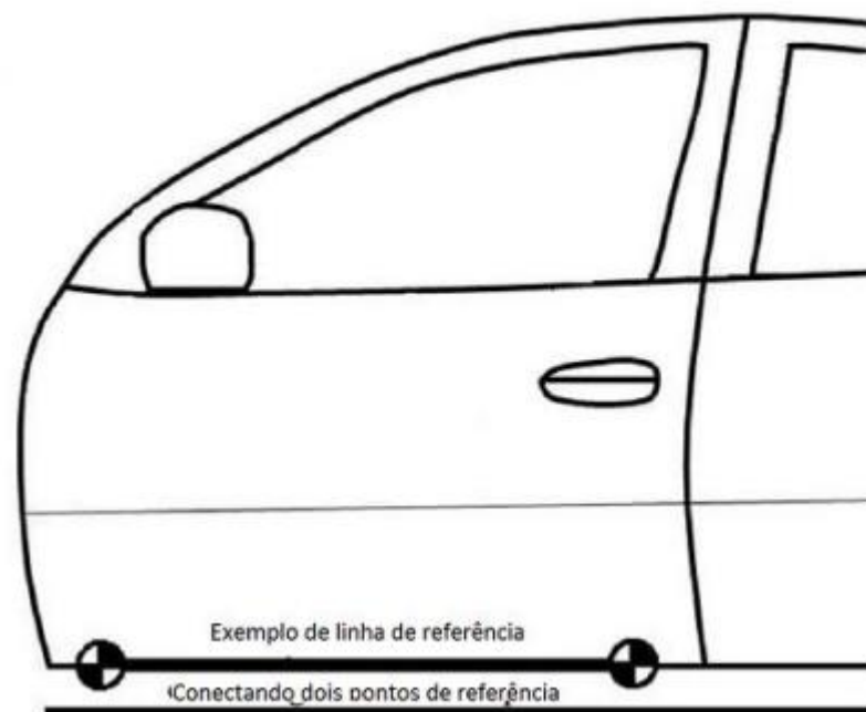
Figura 41 - Exemplo de uma referência linear que liga dois pontos de referência no batente da porta esquerda
