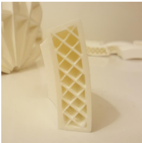
Figura 26 – uma peça do tipo espuma com a função de absorver energia. Esta peça possui espessura arbitrária. A espessura calcula é pelo menos o dobro desta.
