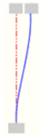
Figura 15- Modo de flambagem na direção z
