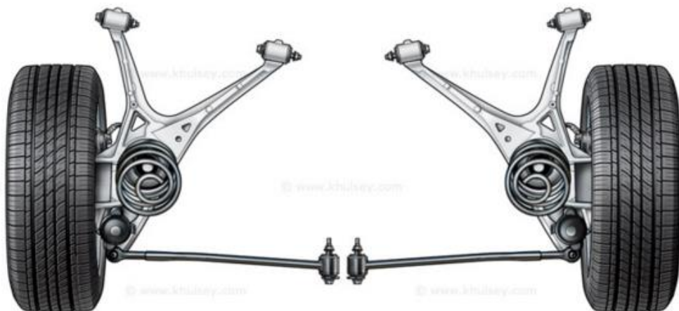
Figura 18. Suspensão tipo braço arrastado traseira. Fonte: www.khulsey.com
