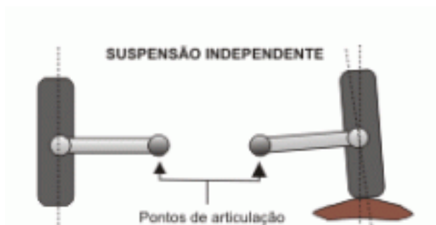
Figura 15. Suspensão independente. Fonte: http://www.carrodegareagem.com/suspensao-independente-como-funciona/
