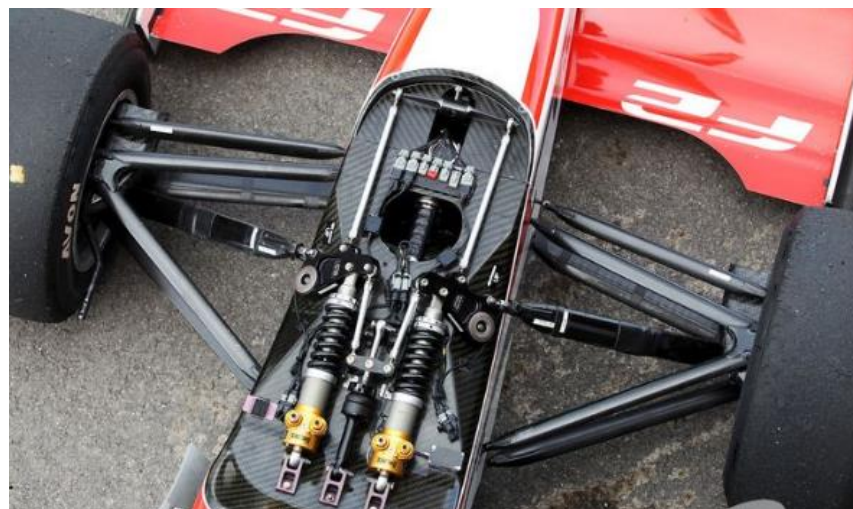
Figura 11. Sistema de suspensão com push rod . Fonte: motorsport.com
