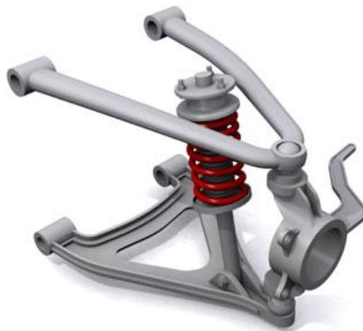
Figura 10. Suspensão do tipo duplo A. Fonte: http://forums.vwvortex.com/showthread.php?5591903-Random-Question-of-the-Day-Cheapest-Car-With-Double-Wishbones
