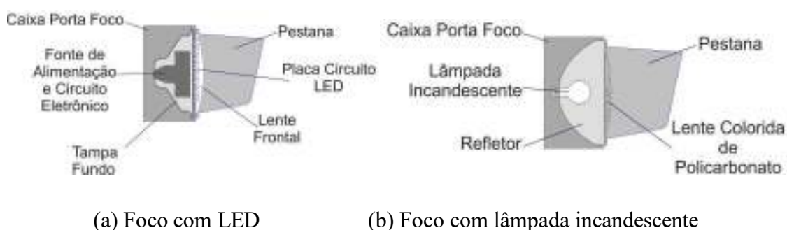
Figura 3.1: Elementos constituintes dos focos semafóricos
