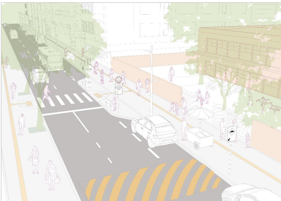
Figura 39 - Via com ondulação transversal antes da travessia de pedestres em frente à escola.
