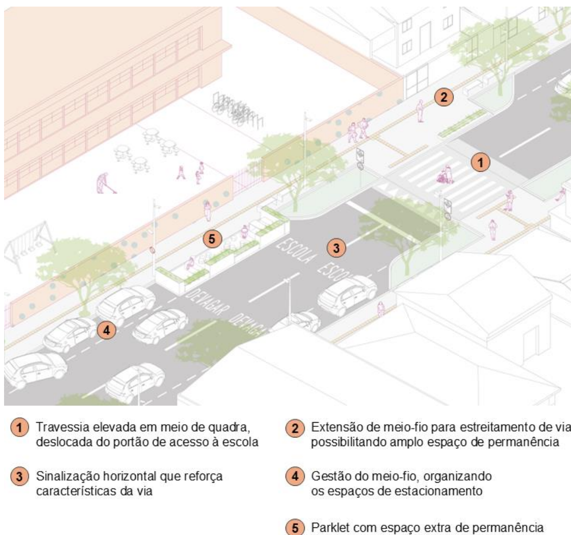
Figura 52 - Exemplo de entrada e saída de escola com tratamento para segurança viária.
