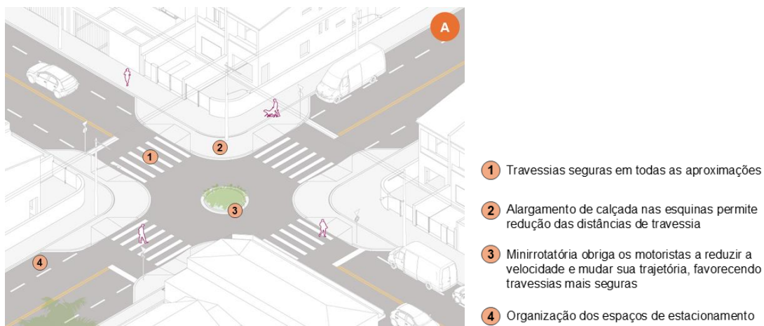
Figura 43 - Região A: elementos para segurança viária utilizados como tratamento de rota escolar segura.
