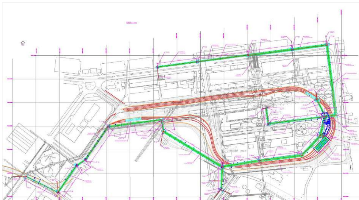
Figura 40 – Novo layout do projeto Cais Leste: nova moega ferroviária (região em azul) para posterior distribuição em esteiras transportadoras (coloração verde) e respectivas torres de derivação (em roxo).
