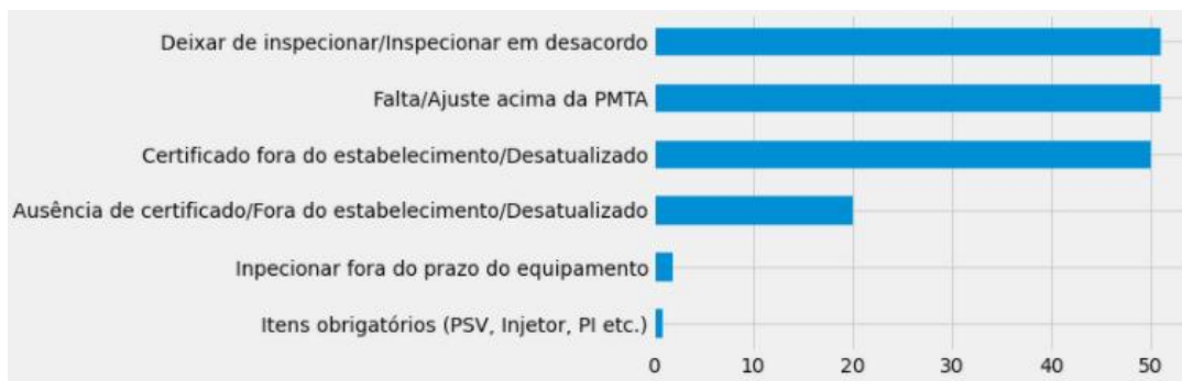
FIGURA 48 - AUTUAÇÕES POR IRREGULARIDADES EM CALDEIRAS - DISPOSITIVOS DE SEGURANÇA
