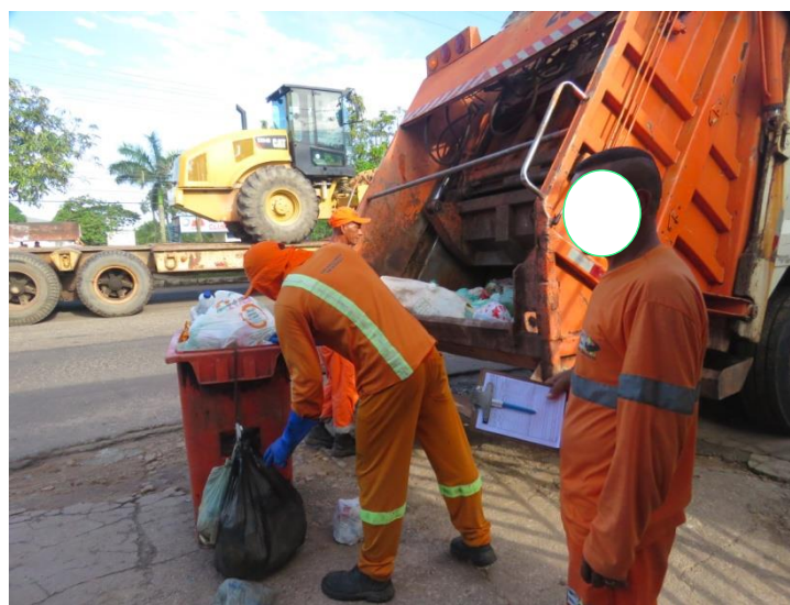
Figura 29 - Perigo de esmagamento na prensa do carro coletor
