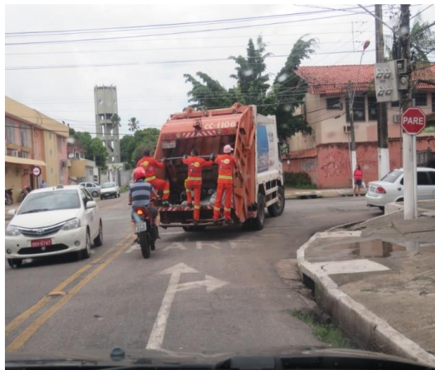
Figura 24 - Perigo de queda das partes externas dos veículos coletores
