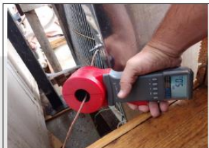
Descrição das medições: Container 19 Valor da resistência do aterramento: R = 5.0 \Omega
