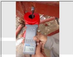
Descrição das medições: Grua Valor da resistência do aterramento: R = 4.3 \Omega
