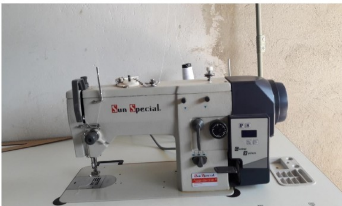
Foto 35 – Máquina de costura profissional, com destaque para o painel de comando digital.
