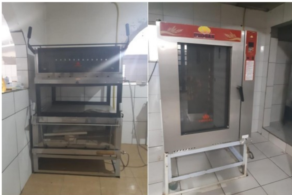
Foto 16 – Esquerda: forno refratário industrial a gás. Direita: Forno industrial com comando digital
