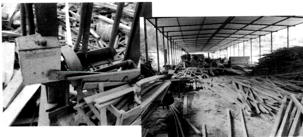
Máquinas com acionamento por chave Lombardi e sem proteção das áreas de perigo na serraria.
