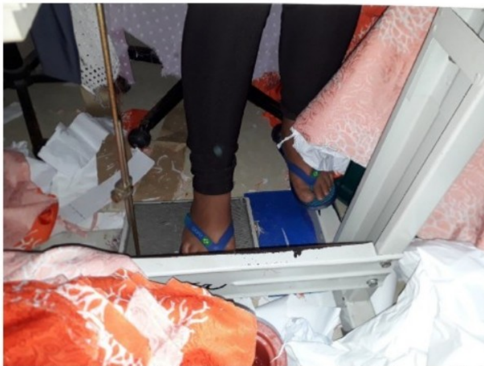
06/11/2018 - OFICINA DE COSTURA Nº 1 - costureiro trabalha com chinelos de dedo. Pernas e pés próximos e acessíveis a partes móveis das máquinas de costura.
