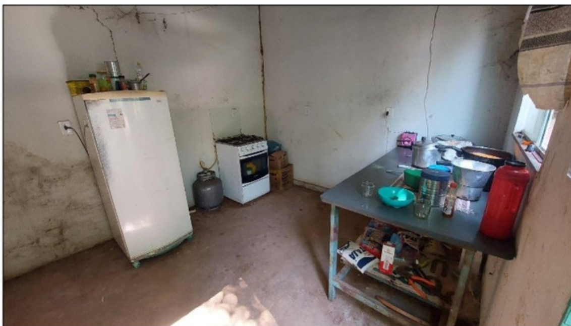
Foto 24: Cômodo utilizado como Cozinha pelo trabalhador [REDACTED] e esposa. No local verifica-se a existência de botijão de GLP no interior da cozinha, em área não ventilada
