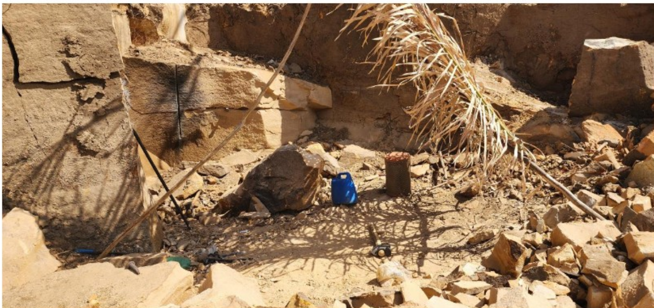
Estrutura precária feita com palha, em posto de trabalho, para proteção contra o sol e rasgo vertical na rocha, enegrecido à sua volta, a revelar a utilização de explosivo para desmonte.
