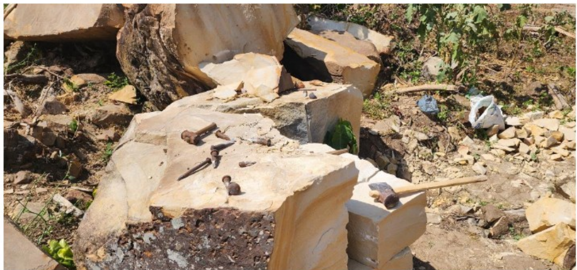
Ferramentas de trabalho (marretas, ponteiros e píxotes) na frente de extração e conformação de pedras.
