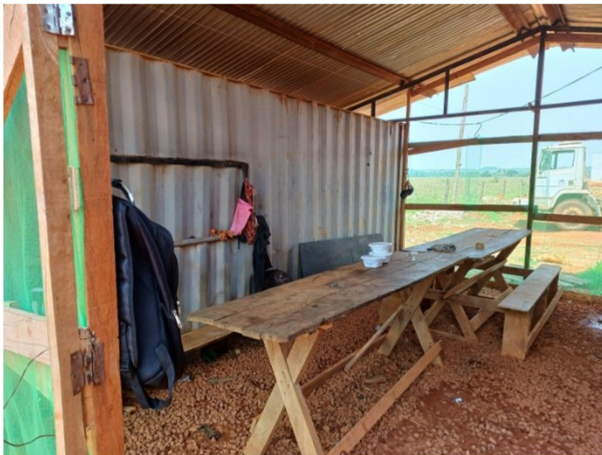
Figura 3 - Local para tomada de refeições no canteiro de obras em desacordo com a NR-24 e utilizado como vestiário
