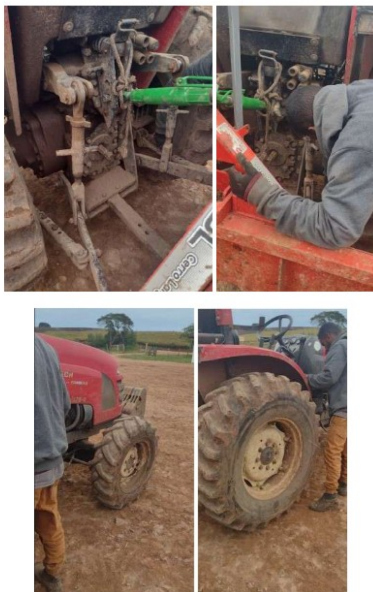
Imagens do trator inspecionado sem qualquer presença de proteção , em suas partes superior ou laterais, nas suas áreas de tomada de potência (TDP)
