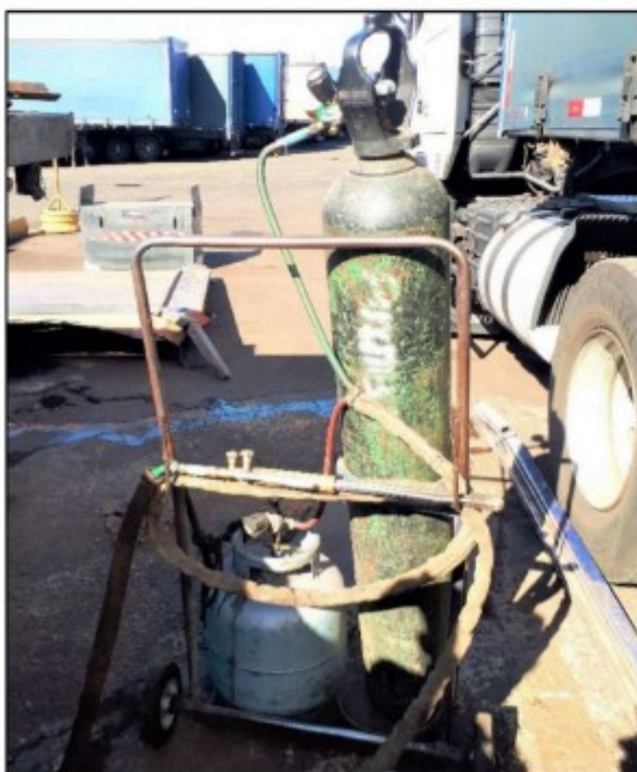
Imagens: Conjunto “oxicorte” abastecido com botijão de GLP, que era utilizado na oficina mecânica da empresa.
