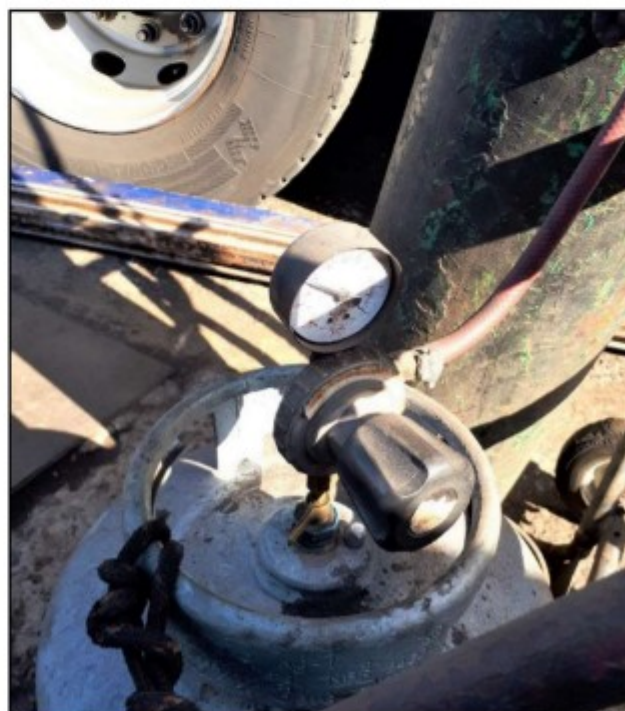
Imagens: Conjunto “oxicorte” abastecido com botijão de GLP, que era utilizado na oficina mecânica da empresa.
