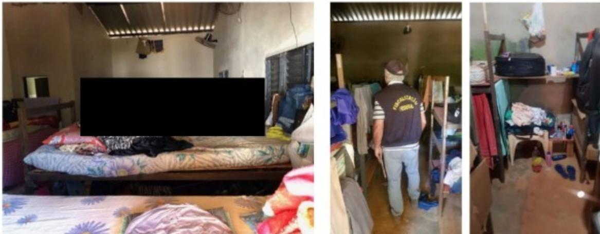
Observamos também super utilização das tomadas elétricas existente com uso de "Ts" que multiplicam a possibilidade de uso das tomadas. Foram ainda encontrados eletrodomésticos como ebulidores elétricos para aquecimento de líquidos, o que não deve ser permitido em dormitórios coletivos. Foi verificada também a existência de rádios e ventiladores, além de carregadores de celulares, o que explica a sobrecarga na utilização das tomadas elétricas.
