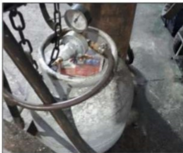
Imagens: Conjuntos oxicorte abastecidos com botijões de gás liquefeito de petróleo (GLP), encontrados nos setores “Oficina Mecânica” e “Suspensão”.
