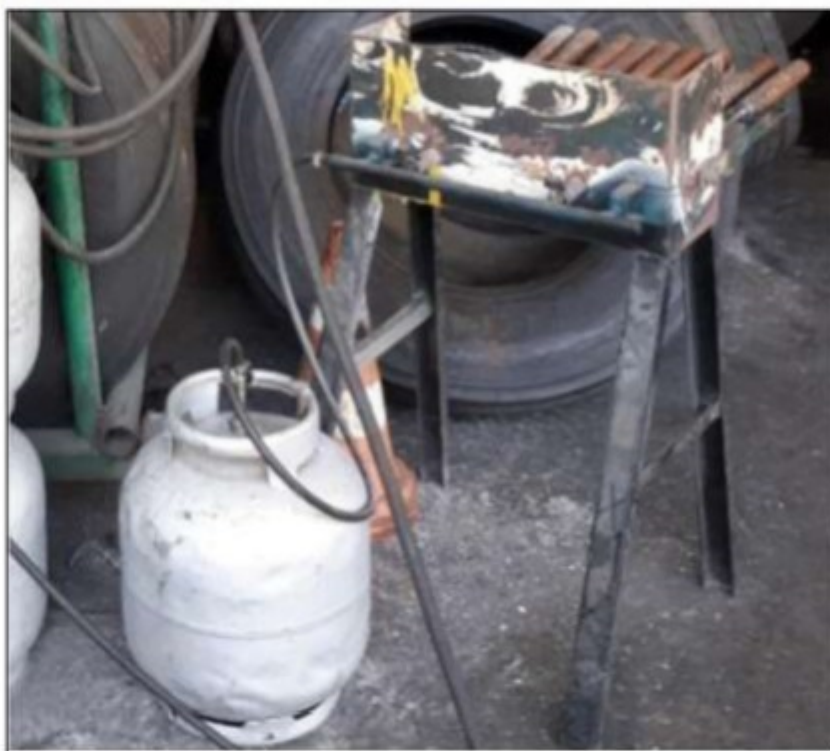
Imagem: Equipamento “marcador de pneus a fogo” acoplado ao botijão de GLP por meio de mangueira de borracha.
