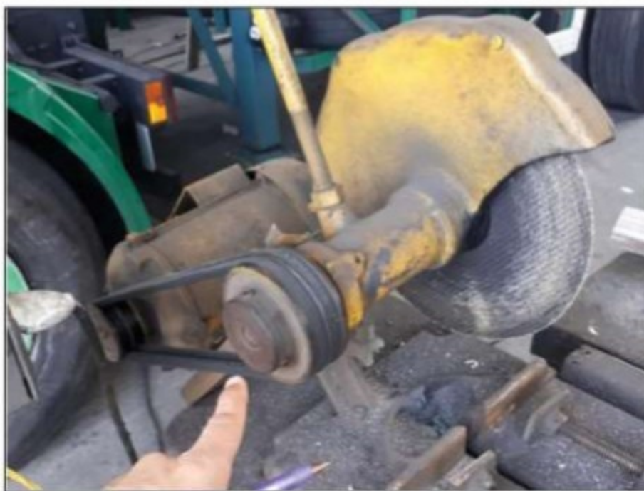
Imagem: Transmissão de força da máquina policorte sem qualquer tipo de proteção.
