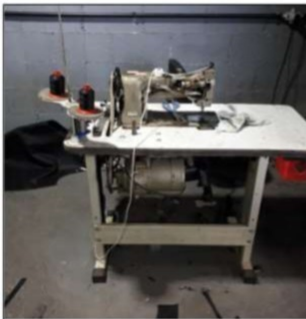
Imagens: Máquina de costura que era utilizada em setor da empresa, sem proteção da transmissão de força.
