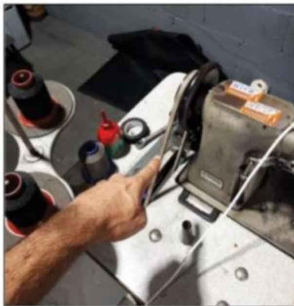
Imagens: Máquina de costura que era utilizada em setor da empresa, sem proteção da transmissão de força.
