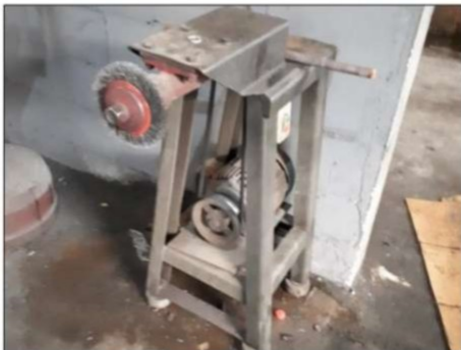
Imagem: Transmissão de força da escova de aço sem qualquer tipo de proteção.
