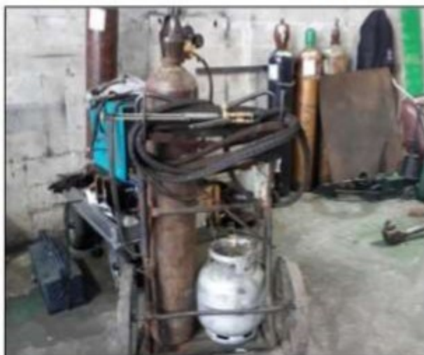
Imagens: Conjuntos oxicorte abastecidos com botijões de gás liquefeito de petróleo (GLP), encontrados nos setores “Oficina Mecânica” e “Suspensão”.
