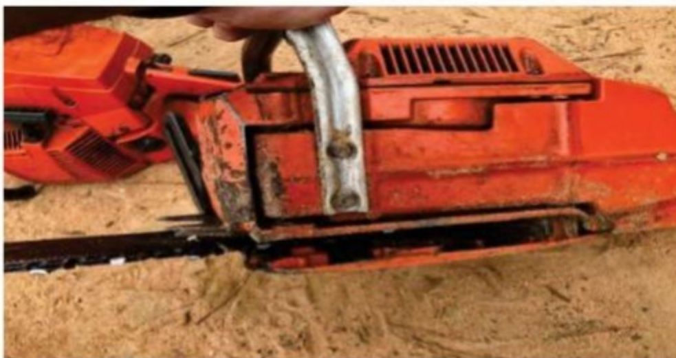
Figura 15: motosserra sem o pino pega-corrente
