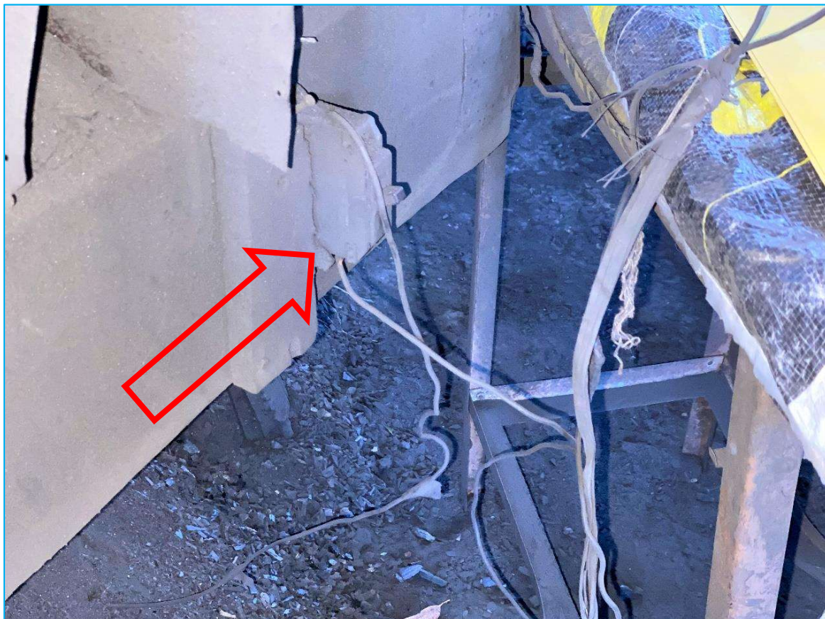
Imagem: Disjuntor e fiação elétrica da peneira classificadora acarretavam riscos de acidentes.
