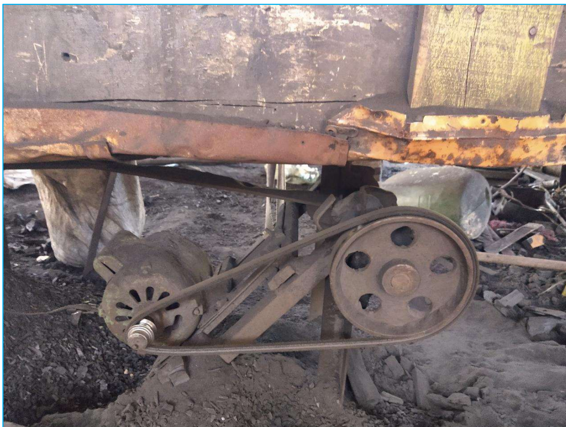
Imagem: Transmissão de força da peneira classificadora exposta.
