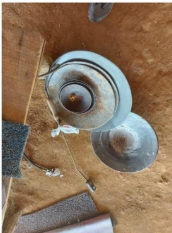
Foto 26: bateias utilizadas pelos trabalhadores no processo de amalgamação do ouro.
