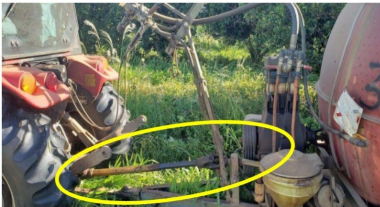
Imagem 27 – Eixo cardã e correias sem proteção, com sérios riscos de acidentes.
