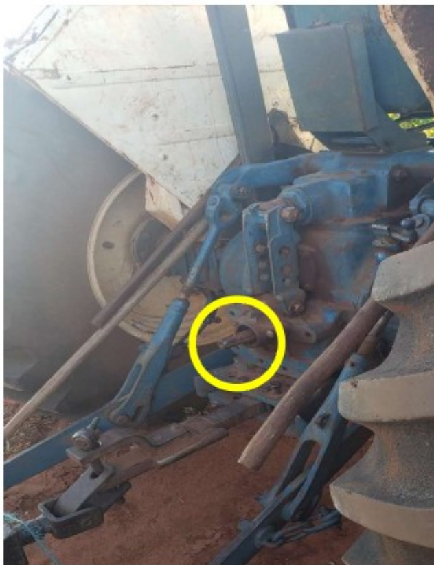
Imagens 21 e 22 – Tomada de Potência (TDP) do trator utilizado pelos trabalhadores resgatados nas atividades de limpeza de terrenos. O dispositivo sem proteção (detalhe) representava riscos de graves acidentes.
