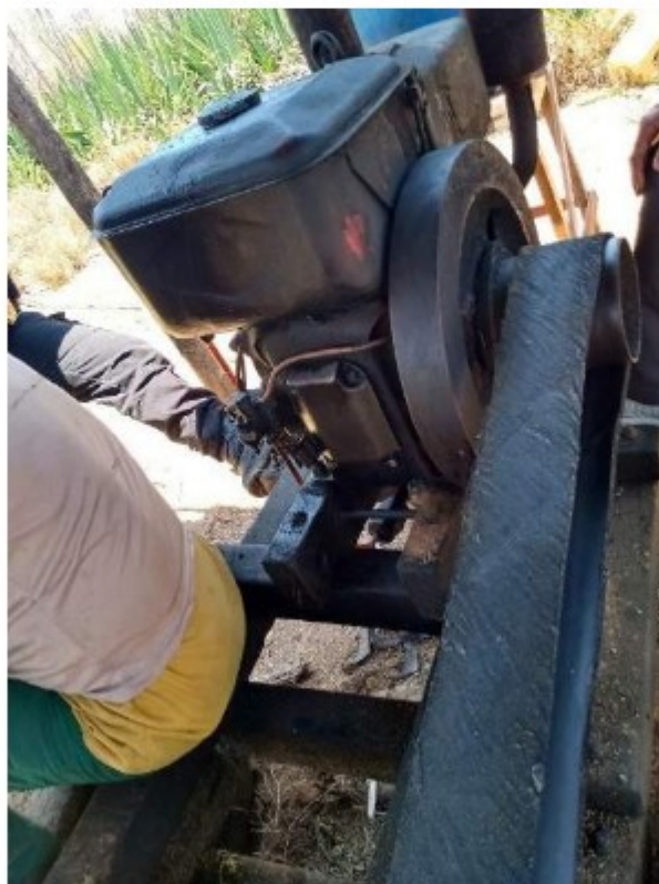
Figura 45 Detalhe da polia sem proteção.
