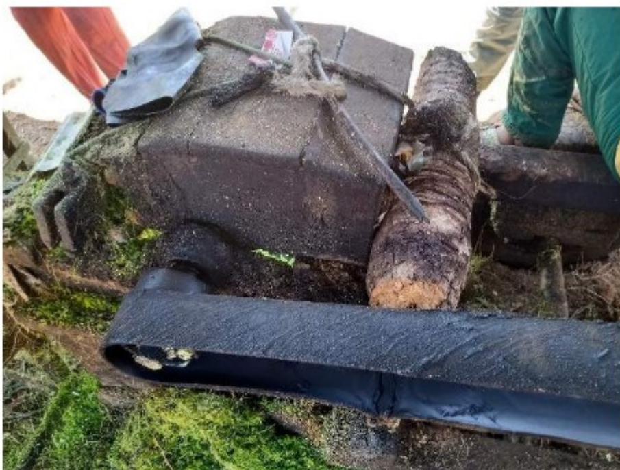
Figura 46 Detalhe da polia sem proteção
