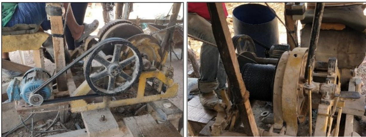
Imagens acima: Guincho utilizado na mina. Não havia proteção das zonas perigosas.
