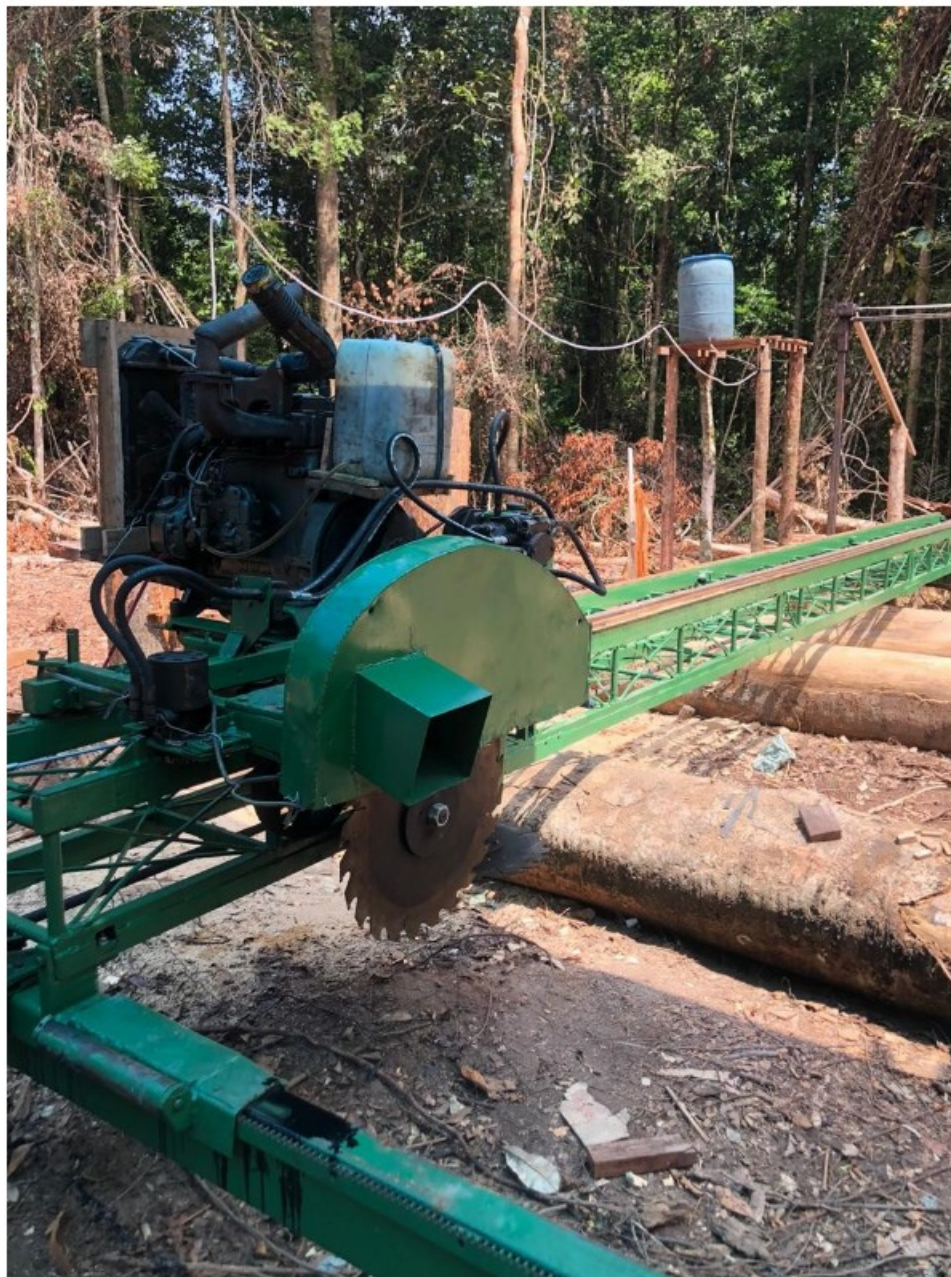
Foto 3: máquina de corte "Induspan" que seria utilizada para desdobrar a madeira.
