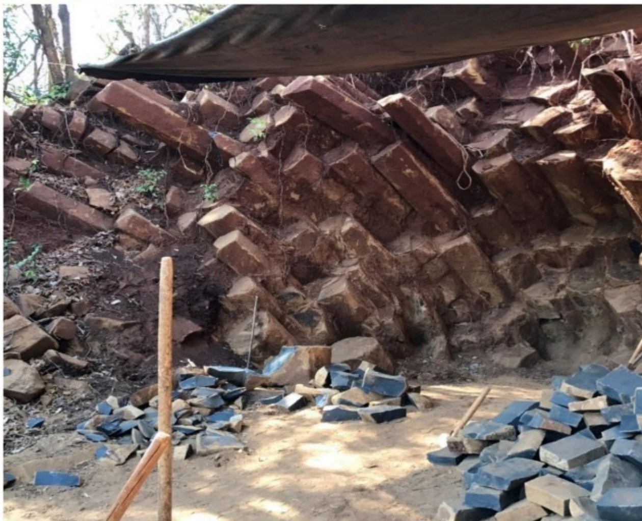
Imagem 23 – Uma das bancadas de extração de rocha de basalto: inclinação negativa, com risco de desabamento sobre os trabalhadores.
